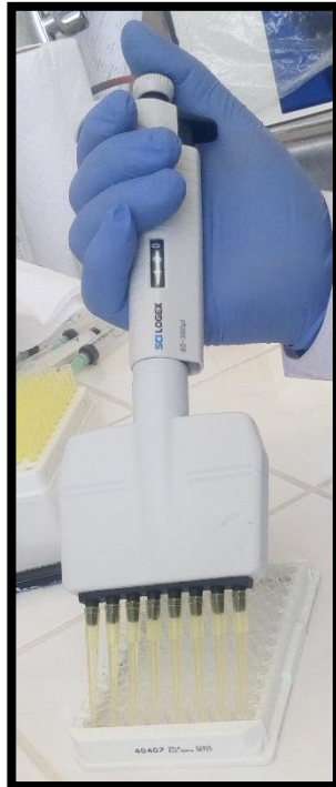
Figura 9. Adición del diluyente
