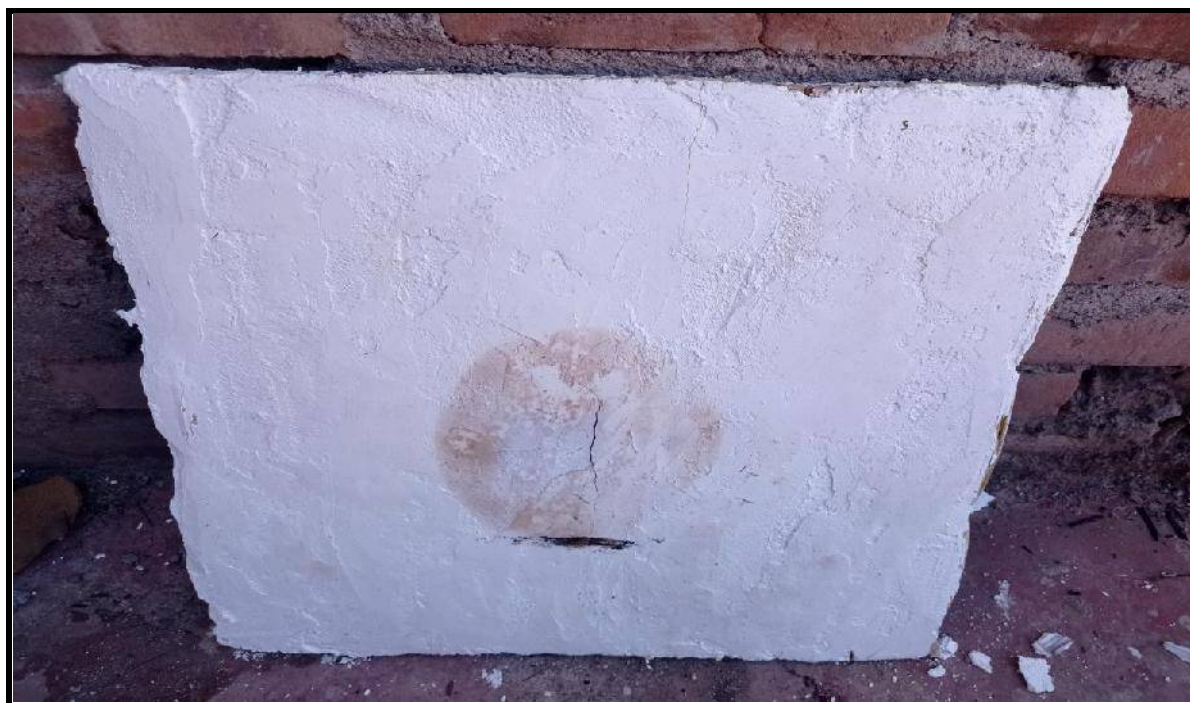
Fotografía 20. RADIO DE QUEMADAURA DE LA CARA NO EXPUESTA EN LOS PANELES REVESTIDOS POR 0.5CM AMBAS CARAS
