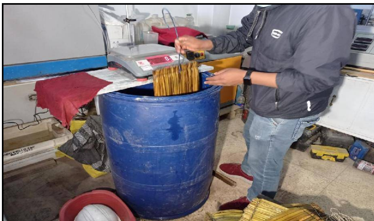
Fotografía 08. INSTALACION DE EQUIPOS PARA REALIZAR EL ENSAYO DE DENSIDAD RELATIVA
