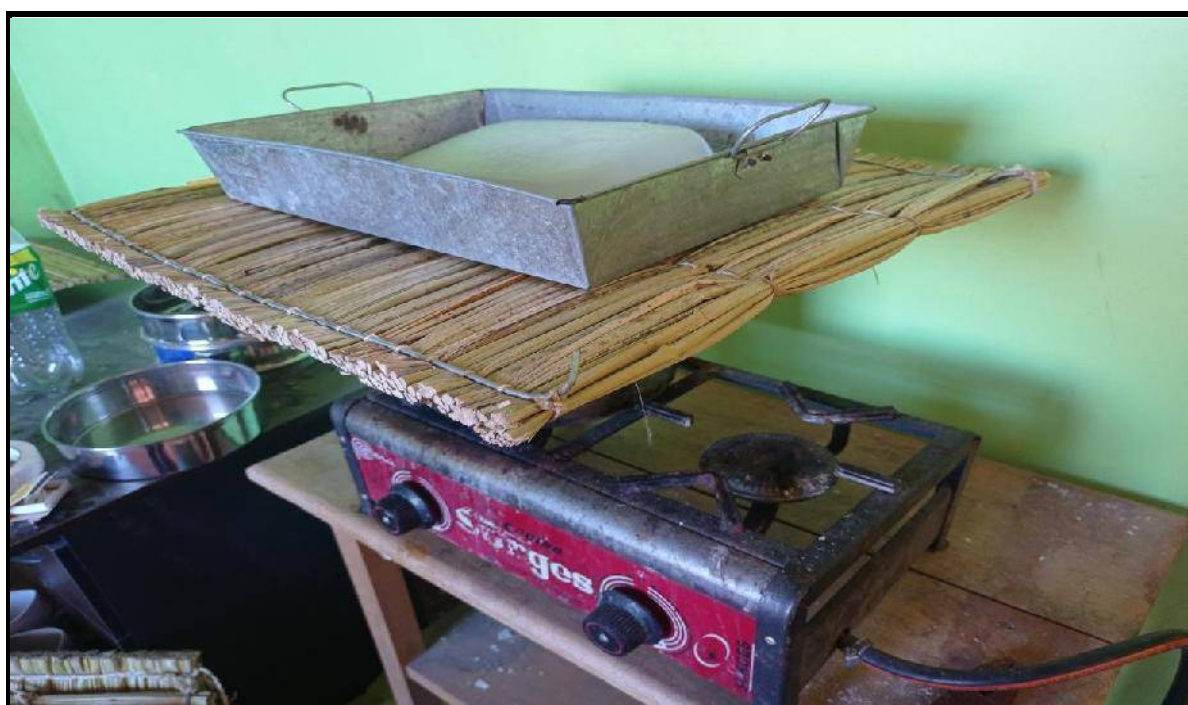
Fotografía 16. ENSAYO DE CONDUCTIVIDAD TERMICA AL PANEL DE TOTORA
