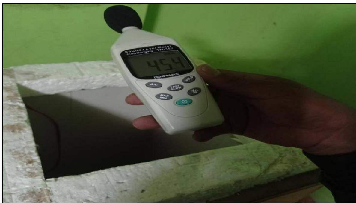
Fotografía 15. LECTURA CON EL SONOMETROS DE LA CAJA ACUSTICA SIN AISLANTE
