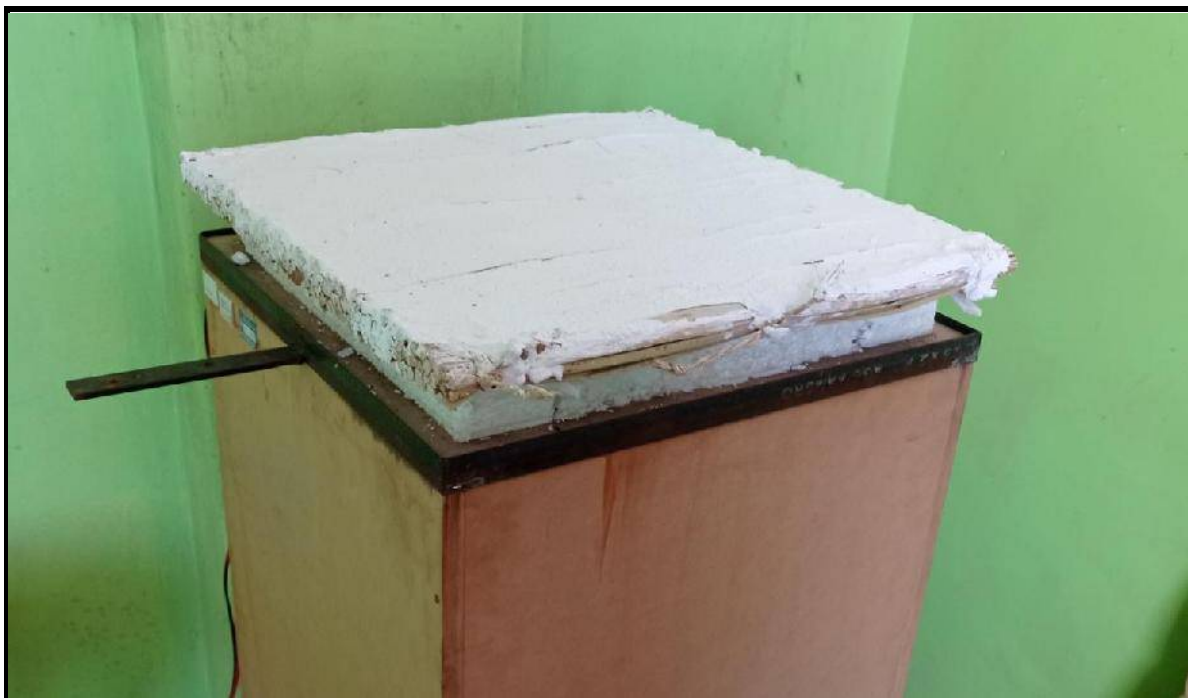
Fotografía 14. ENSAYO DE AISLAMIENTO ACUSTICO AL PANEL REVESTIDO CON YESO 05CM
