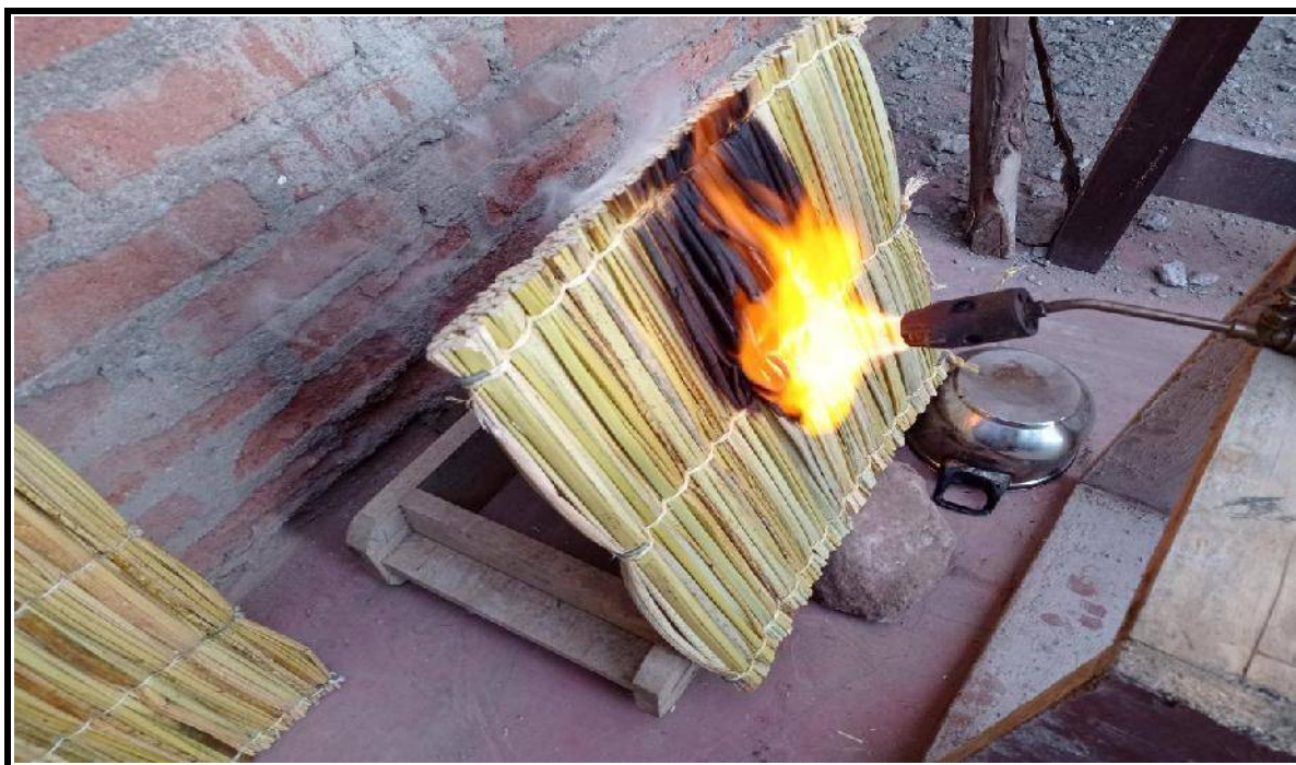
Fotografía 18. ENSAYO DE RESISTENCIA AL FUEGO A LOS DIFERENTES PANELES DE TOTORA
