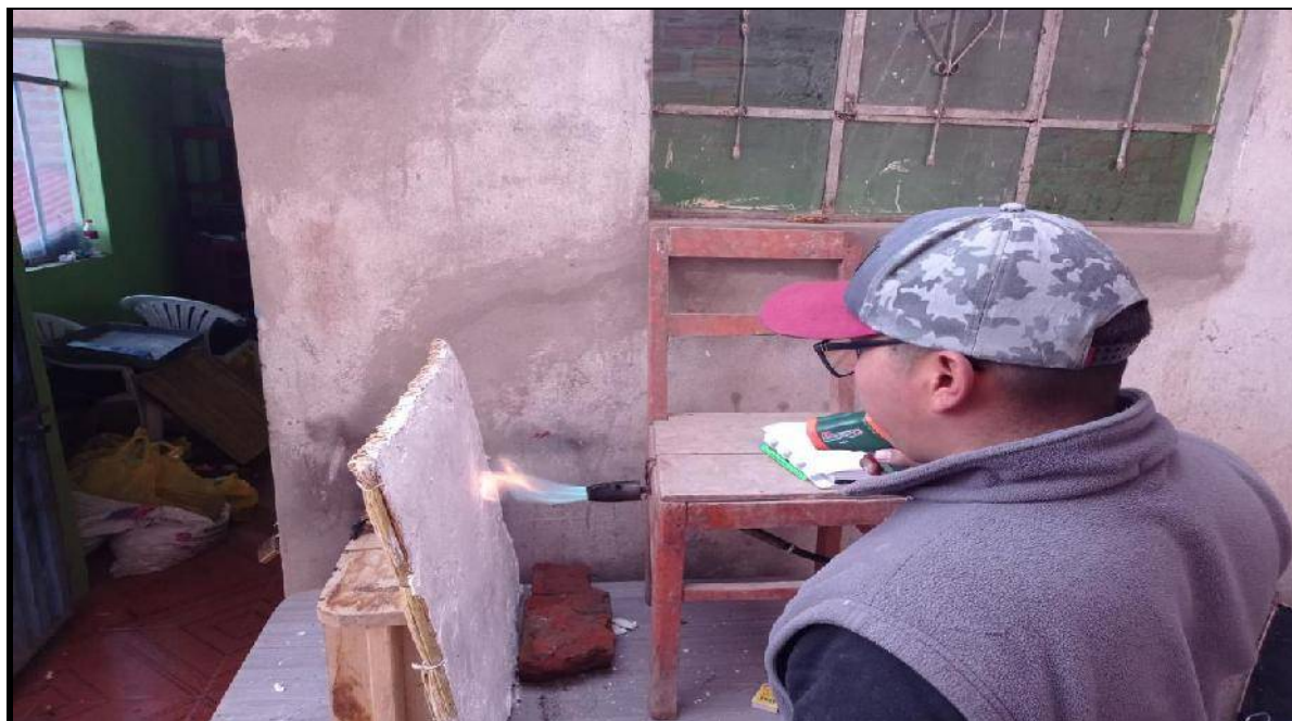
Fotografía 19. ENSAYO DE RESISTENCIA AL FUEGO A LOS PANELES REVESTIDOS CON YESO
