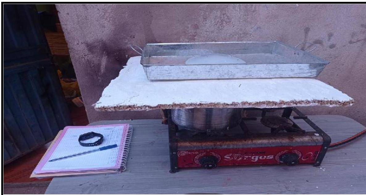
Fotografía 17. ENSAYO DE CONDUCTIVIDAD TERMICA AL PANEL DE TOTORA REVESTIDA CON YESO
