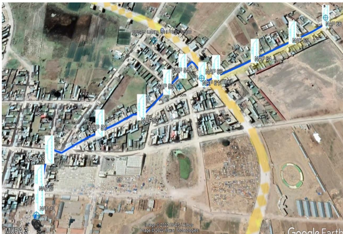
Figura 31 : Cable de fibra de distribución 5.
