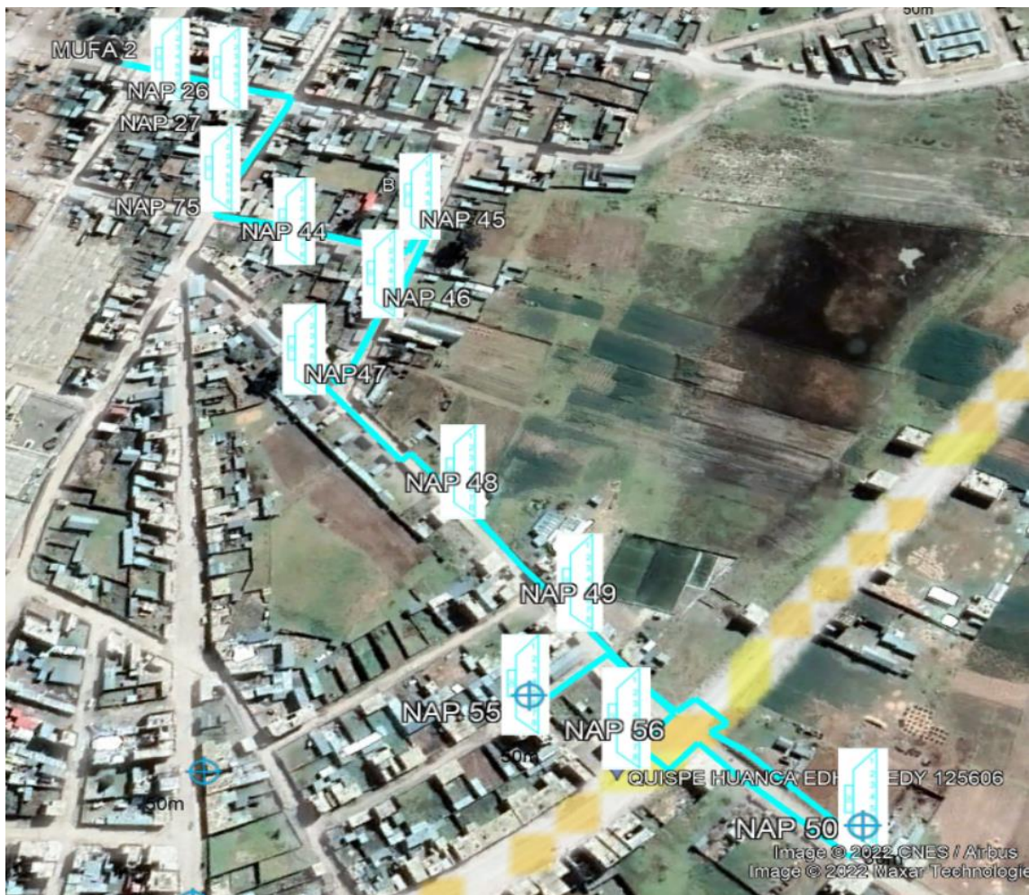
Figura 30 : Cable de fibra de distribución 4.
