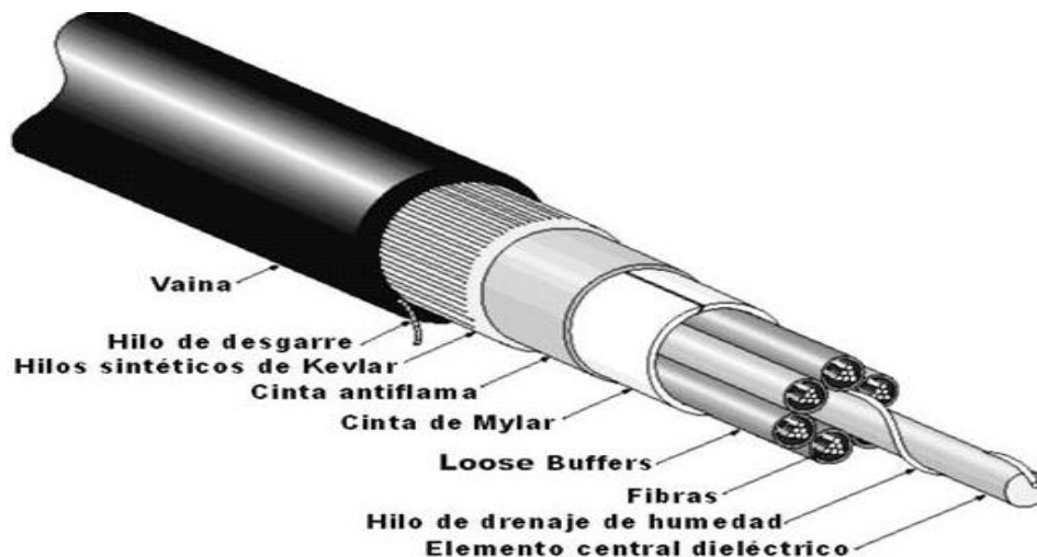
Figura 1 : Composición del cable de fibra óptica.
