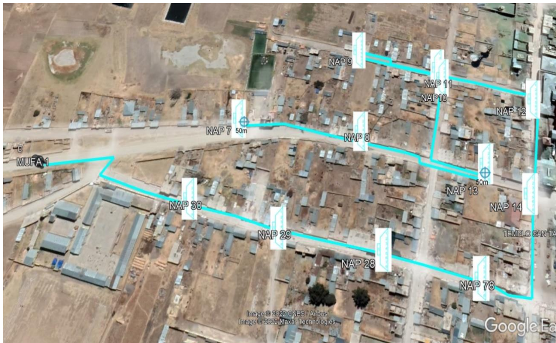
Figura 28 : Cable de fibra de distribución 2
