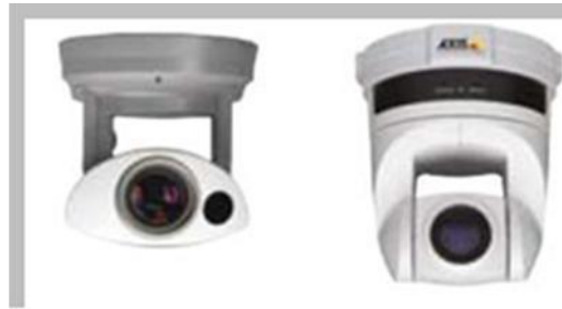
Figura N°9. Cámaras PTZ mecánica.
