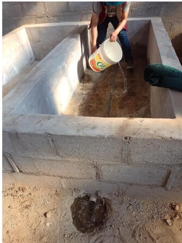
**Figura 39.** Prueba de filtración en las camas de vermicompost
