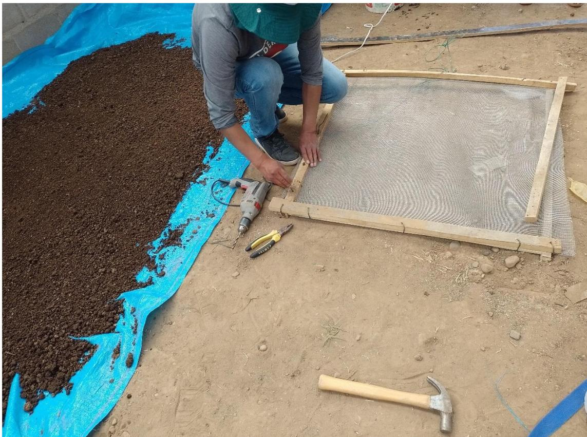
**Figura 61.** Preparación de tamizador de 2mm
