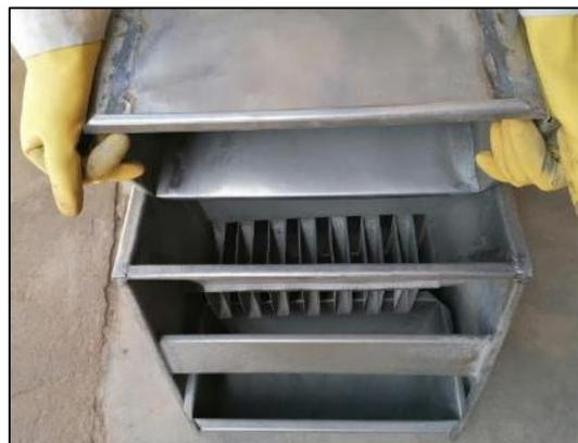
*Figura 18.* Cortador de canaletas.
