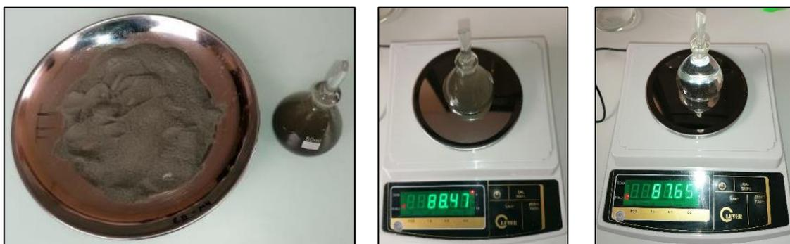
*Figura 22.* Determinación de la densidad de las muestras.
