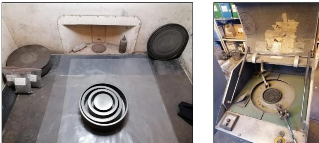
*Figura 20. Pulverizador de anillos para preparación de muestras***Fuente:** Autor
