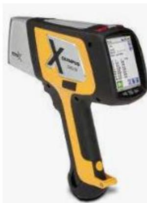
*Figura 24.* Analizador portátil DELTA con Fluorecencia de rayos X.
