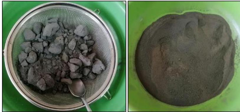
*Figura 17.* Desintegrado y homogenizado de muestras
