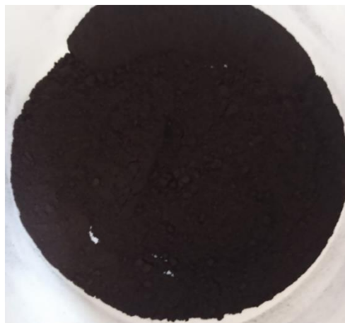
Catalizador de biocarbón de lodo impregnado con Co, Zn y Fe.
