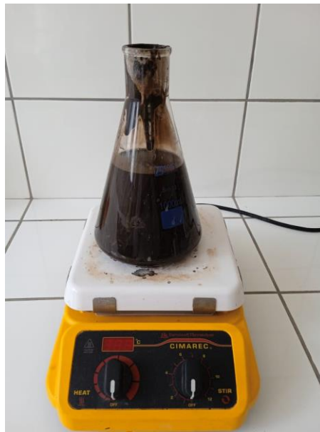
Tratamiento de lodos con nitrato de cobalto
