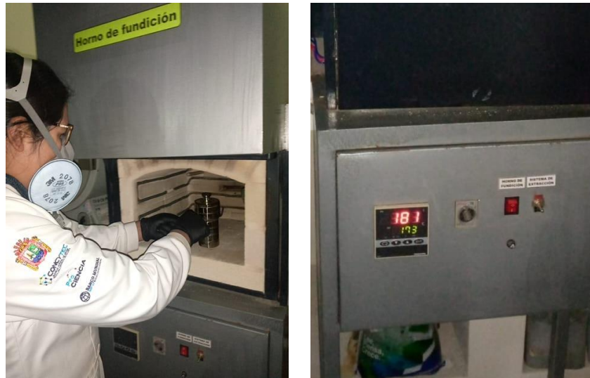
Proceso de impregnación por Síntesis Hidrotermal a 180°C
