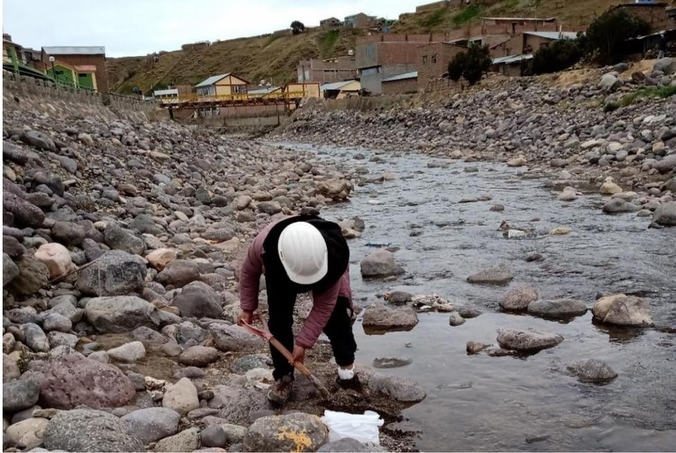
La extracción de las muestras se realizó a nivel del lecho del río (en la superficie), como se observa en la Figura 8; en el cauce del río se vio la presencia de gravas y de bolonería, para el presente estudio no se tomó en cuenta dichos materiales, debido a que cuando el caudal del río aumenta se pudo observar que dicho material puede ser arrastrado con normalidad. Siendo así estudiado el material de la matriz del río.
