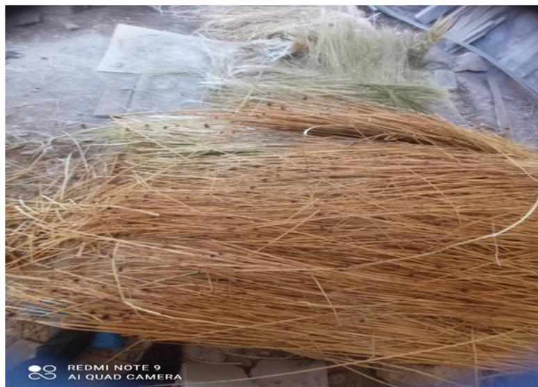
**Figura 12.** Protección de concreto fresco con chilligua de los andes y totora
