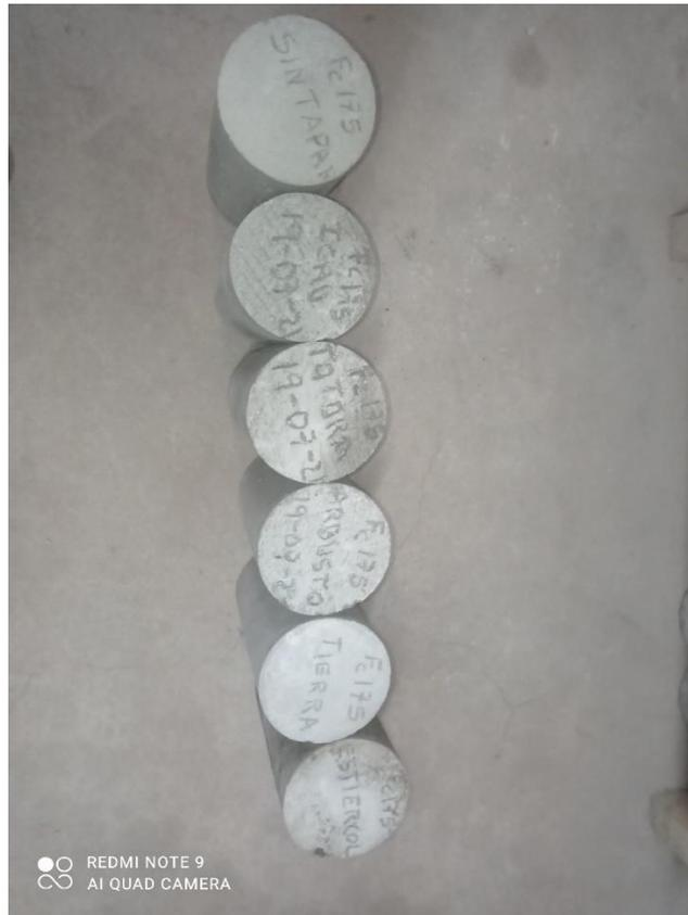
Fotografía: Muestra de los testigos (briquetas) concreto 175 kg/cm<sup>2</sup>
