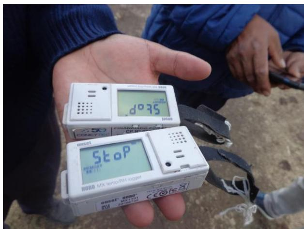
**Figura 14.** Termohigrómetros digital – Data looger
