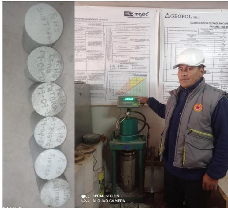
**Figura 19.** Ensayo de la rotura de los cilindros de concreto
