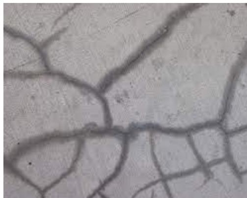
**Figura 4.** Agrietamiento del concreto por retracción plástica
