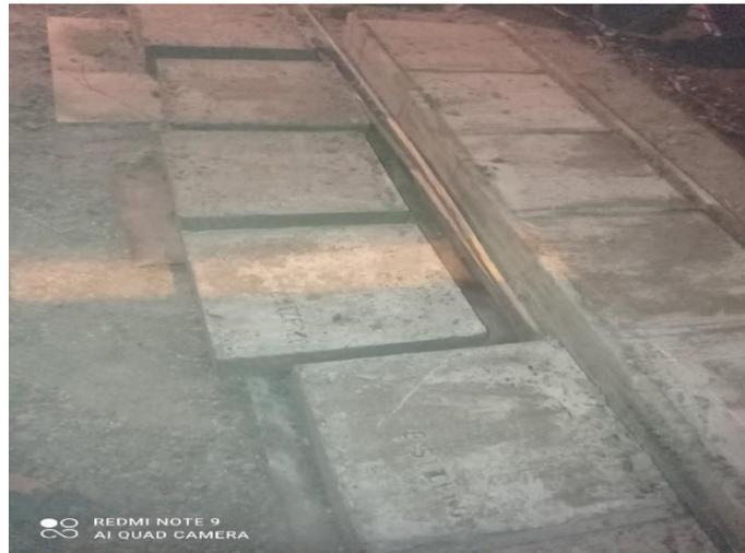
**Figura 13.** Losa de concreto protegido con estiércol de corral
