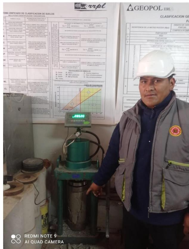
Fotografía: Ensayo de la resistencia a la compresión simple del concreto 175 kg/cm<sup>2</sup>
