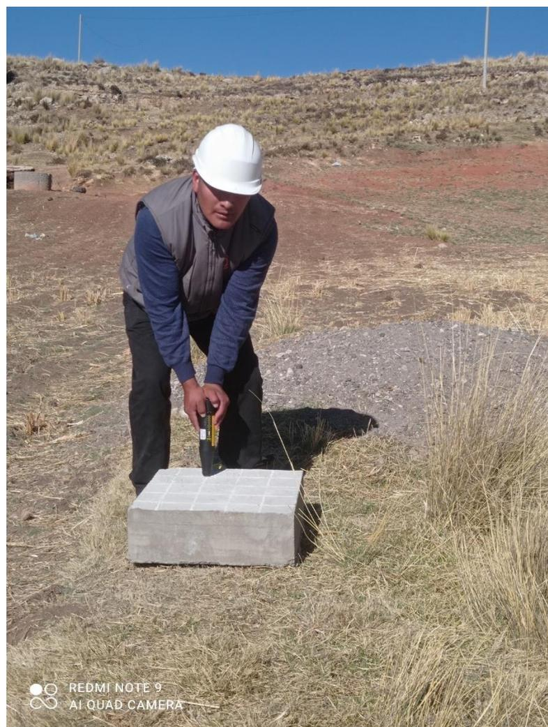
Fotografía: Ensayo de la resistencia superficial del concreto  $175 \text{ kg/cm}^2$  en losas
