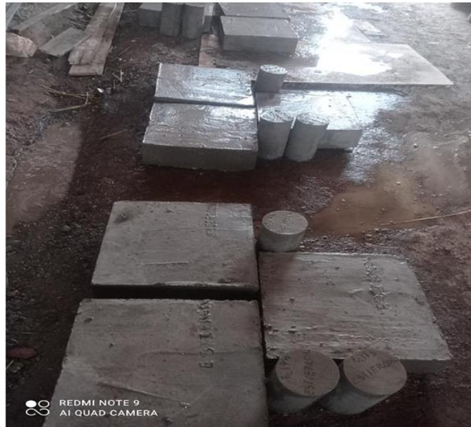
**Figura 10.** Losa y briquetas de concreto protegido con estiércol de corral
