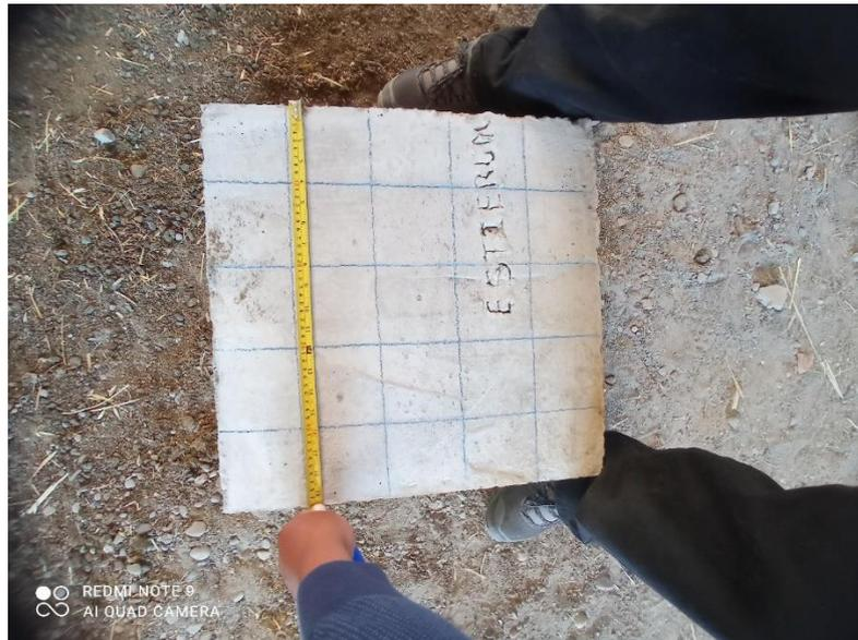
Fotografía: Preparado de losas para el ensayo de la resistencia superficial del concreto
