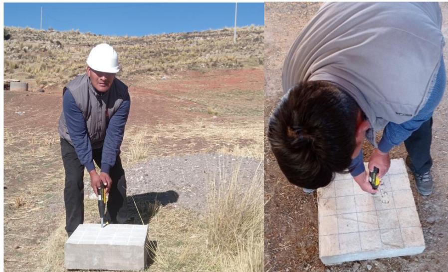
**Figura 17.** Ensayo de la resistencia superficial del concreto con esclerómetro
