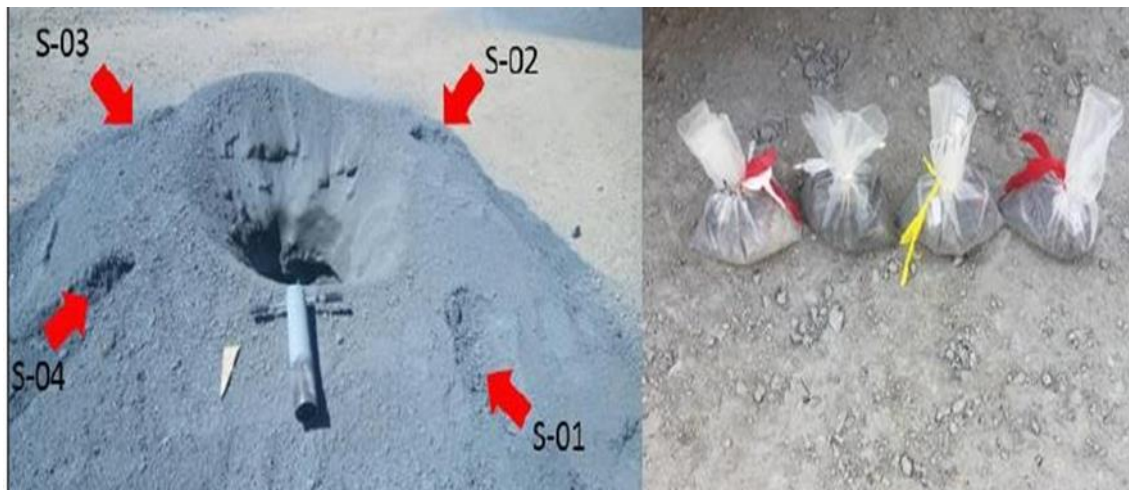
Figura 13. Muestreo siguiendo la secuencia de inserciones.
