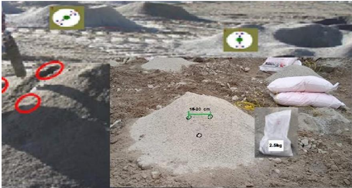
Figura 60. Protocolo de inserciones con auger en la cantera Negro Africano (Calquiya).
