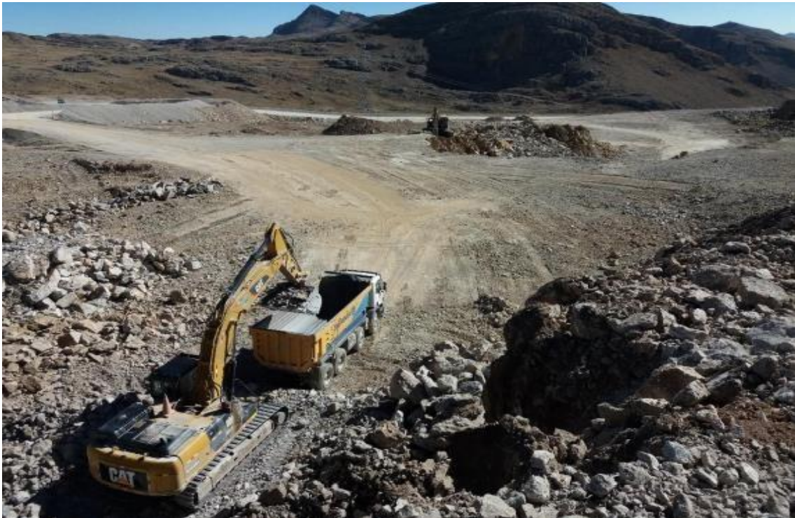
Figura 45. Carguío excavadora de CAT 336 DL, a un volquete de 20m 3 en la cantera el Negro Africano.
