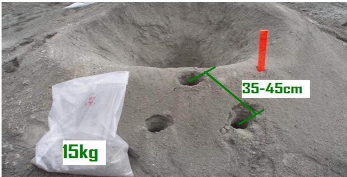
Figura 15. Metodología de las inserciones durante la toma de muestra.
