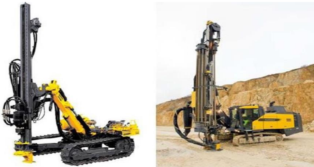
Figura 5. Perforadora, Track-Drill, con martillo en cabeza y con martillo en fondo.
