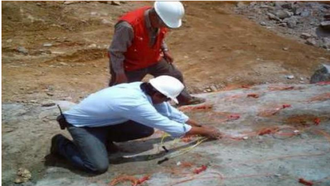
Figura 6. Secuencia de amarre de taladros en una cantera.
