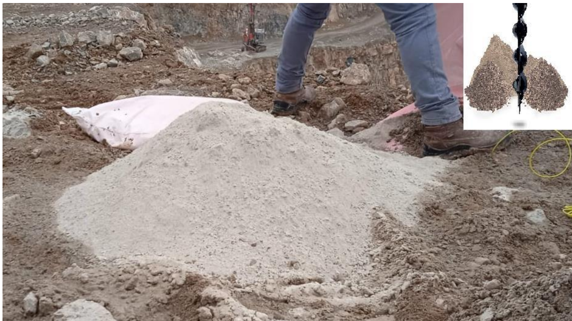
Figura 59. Inserciones con auger en la cantera Negro Africano (Calquiya).
