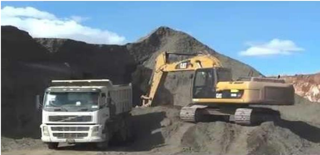
Figura 7. Carguío de mineral con una excavadora
