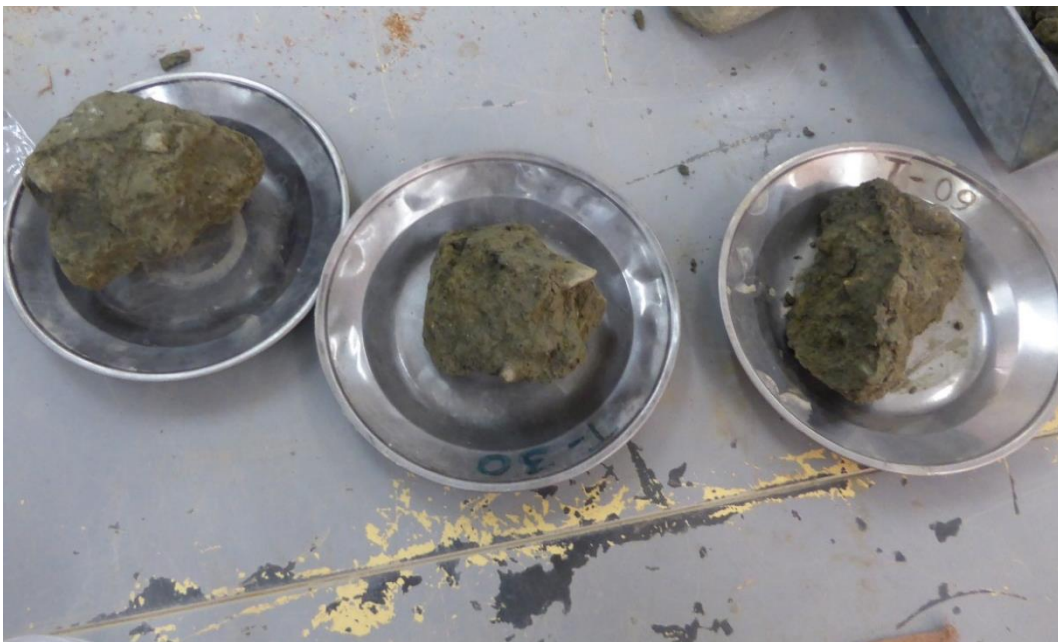
Fotografía 3. Toma de muestra en campo – parafinado
