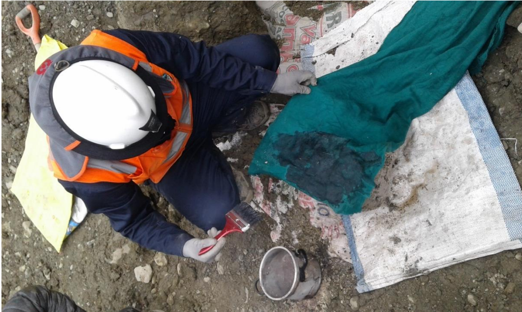
Fotografía 3. Toma de muestra en campo – parafinado
