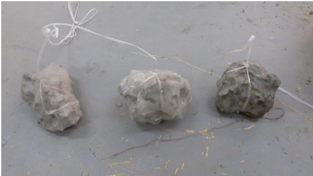
Fotografía 5. Desarrollo de ensayo de propiedades índice- parafinado
