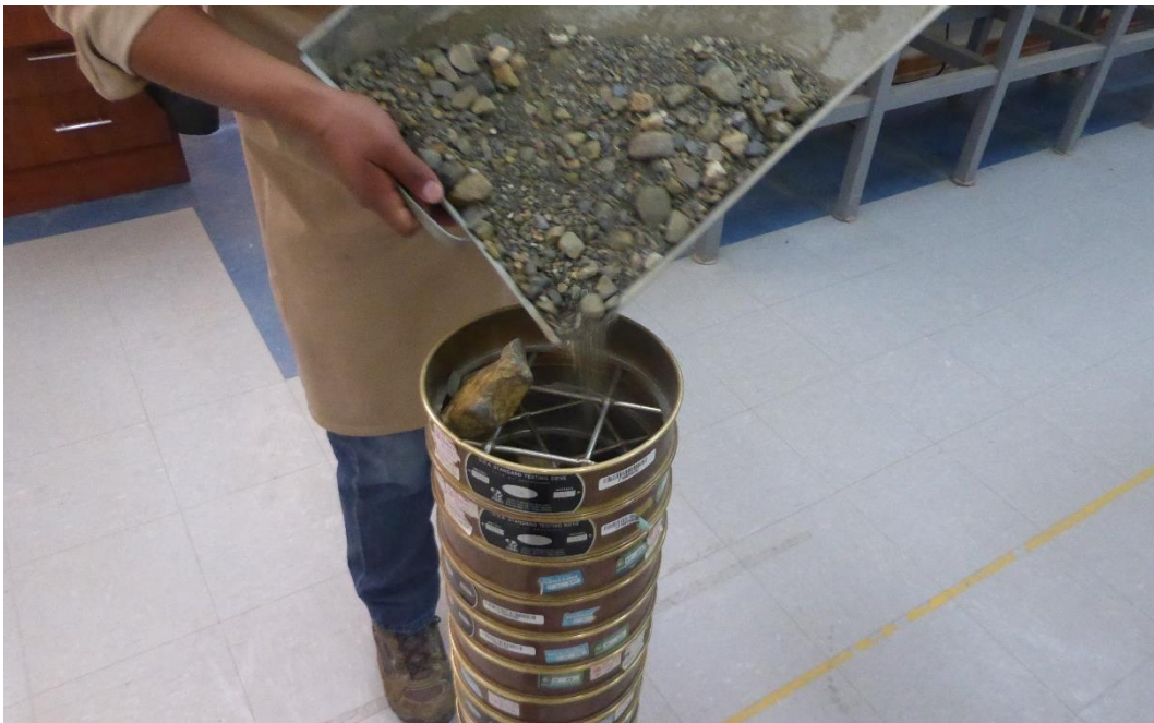
Fotografía 6. Desarrollo de ensayo de análisis granulométrico.
