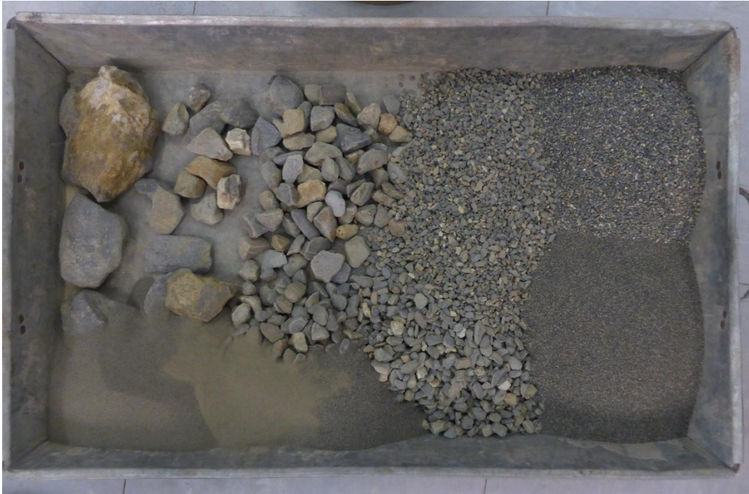
Fotografía 7. Distribución granulométrica de suelo en calicata N°. 01 y N°. 02
