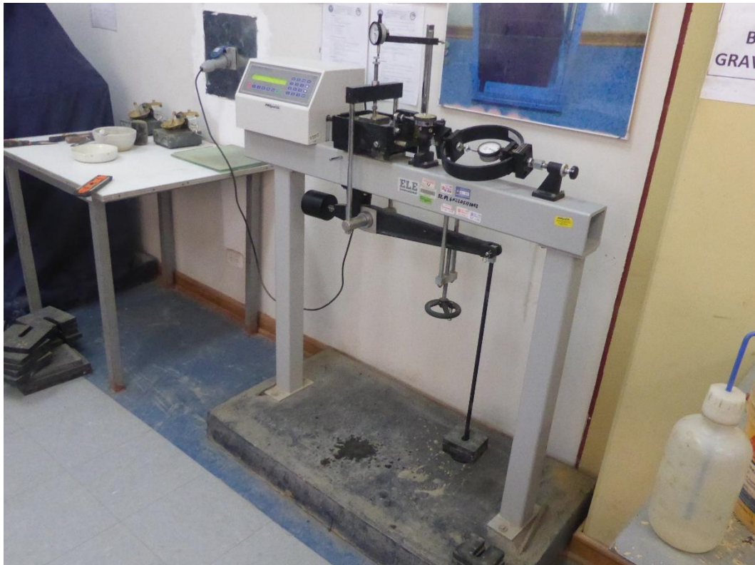
Fotografía 9. Desarrollo de ensayo de corte directo.
