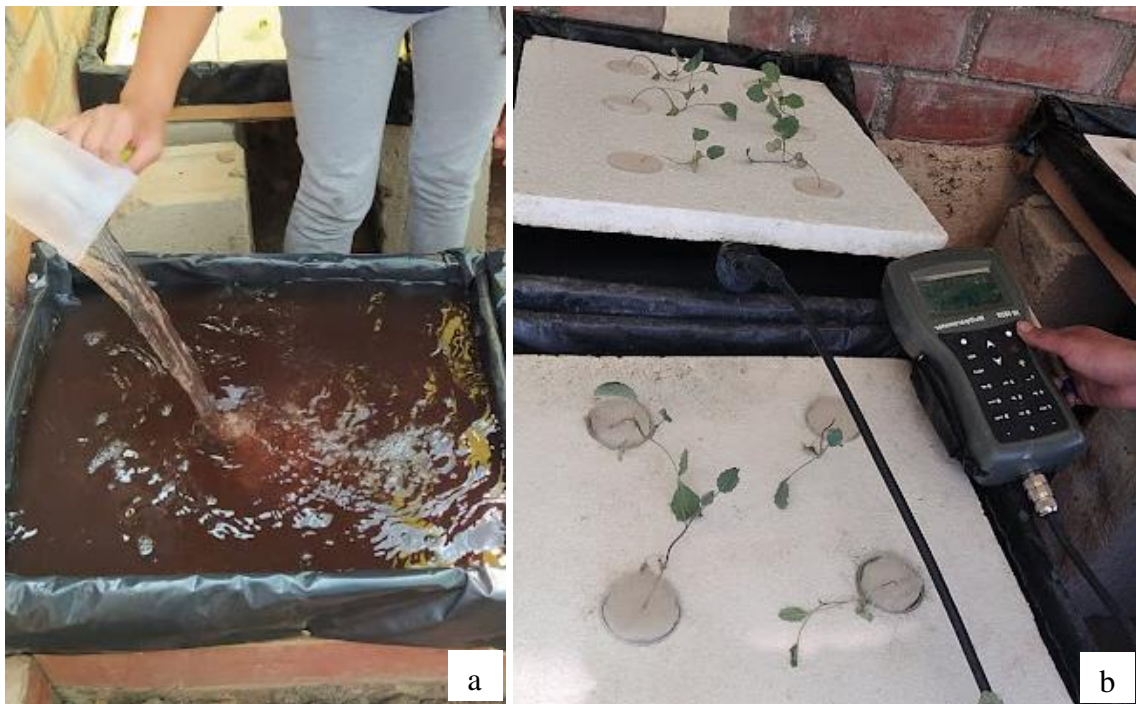
Anexo 10. Monitoreo; a. oxigenación de la solución nutritiva, b. medición de los parámetros de agua
