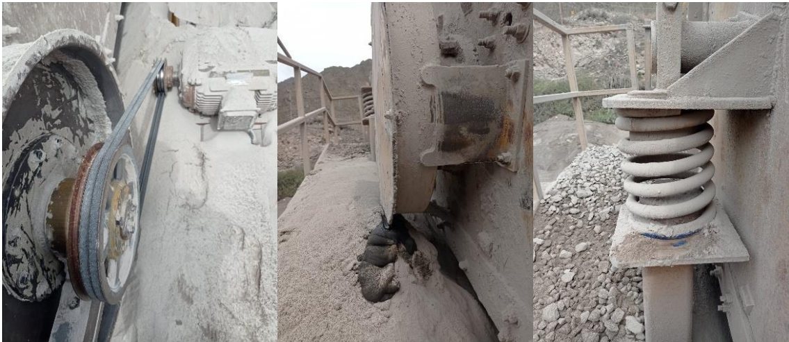
Figura 58: Defectología en componentes de zaranda.
