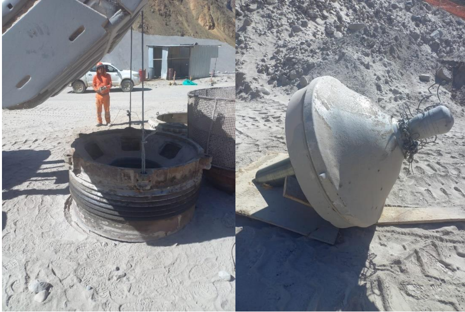
Figura 56: Reparación de mantos de cono, para mejora de trituración.
