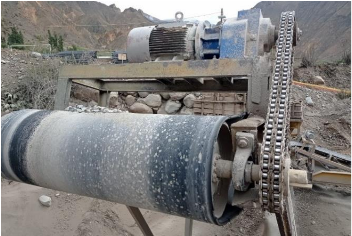
Figura 59: Eje de Polea Motriz torcido por sub dimensionamiento.
