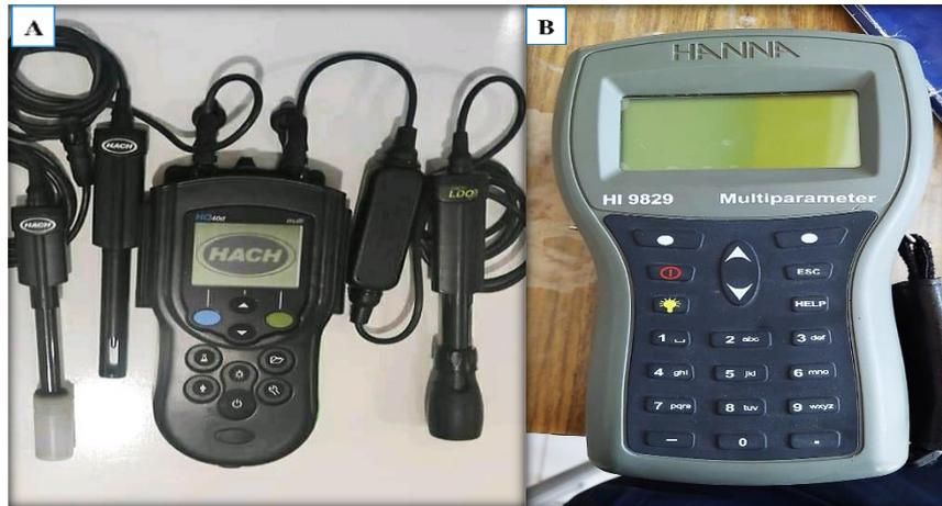
**Figura 14.** En la figura se presenta los equipos que se utilizó para la toma de datos de los parámetros fisicoquímicos en campo in-situ. **A)** Se muestra el multiparámetro portátil HQ40D de Hach, utilizado en la 1ra salida a campo. **B)** Se aprecia el multiparámetro Hanna HI 9829, se hizo uso en la 2da salida a campo.
