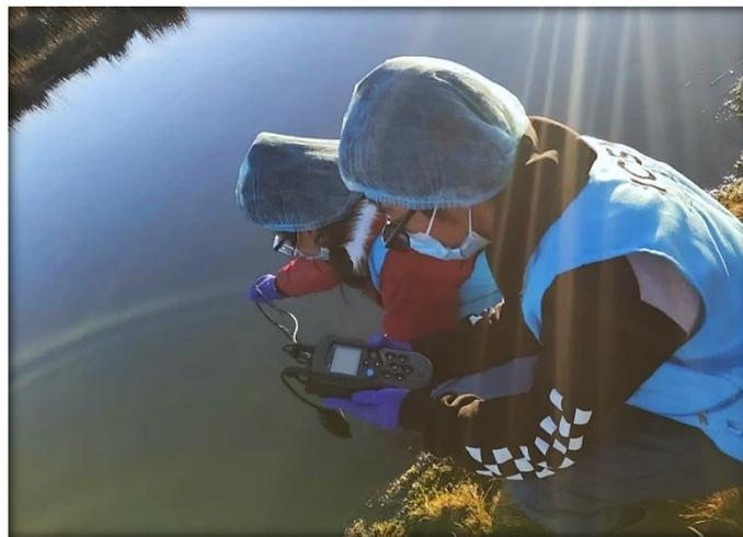
**Figura 16.** Estación de muestreo TorcM2. Se presenta la obtención de datos de los parámetros fisicoquímicos en campo, con el equipo multiparámetro portátil HQ40D de Hach. Fecha 18/06/2021, correspondiente al 1er monitoreo.
