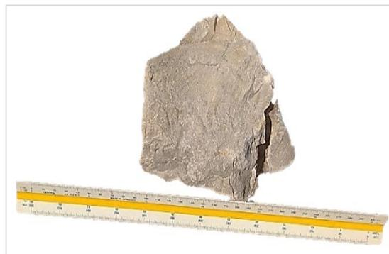
**Figura 43.** Muestra de mano de roca caliza de la Fm. Ayabacas E:385826.8 - N: 8286462.8
