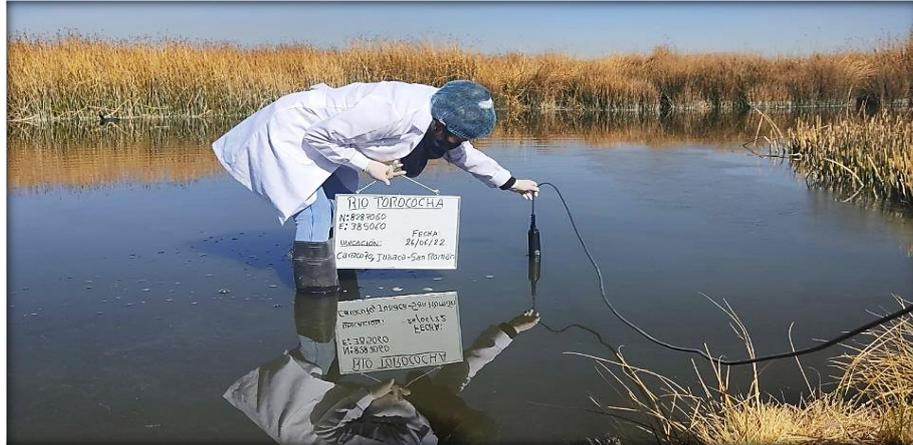
**Figura 15.** Estación de muestreo TorcM1. Se observa la obtención de datos de los parámetros fisicoquímicos en campo, con el equipo multiparámetro Hanna HI 9829. Realizado en el 2do monitoreo, fecha 26/06/2022.
