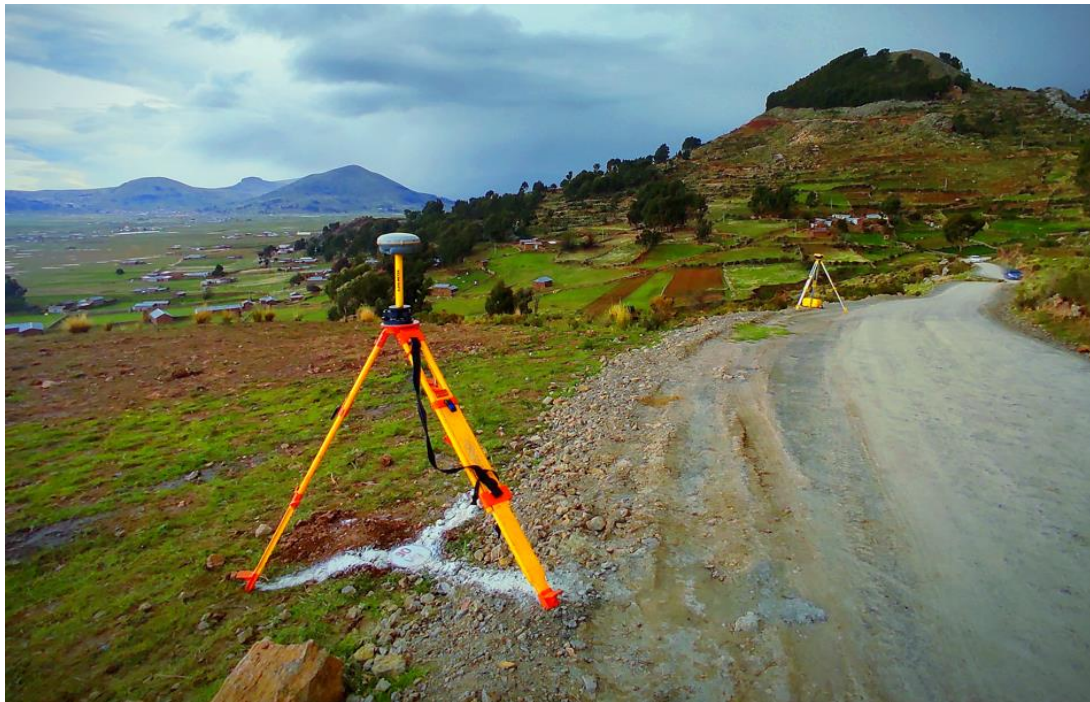
Figura 12: Georreferenciación del BM-06 en método Estático.
