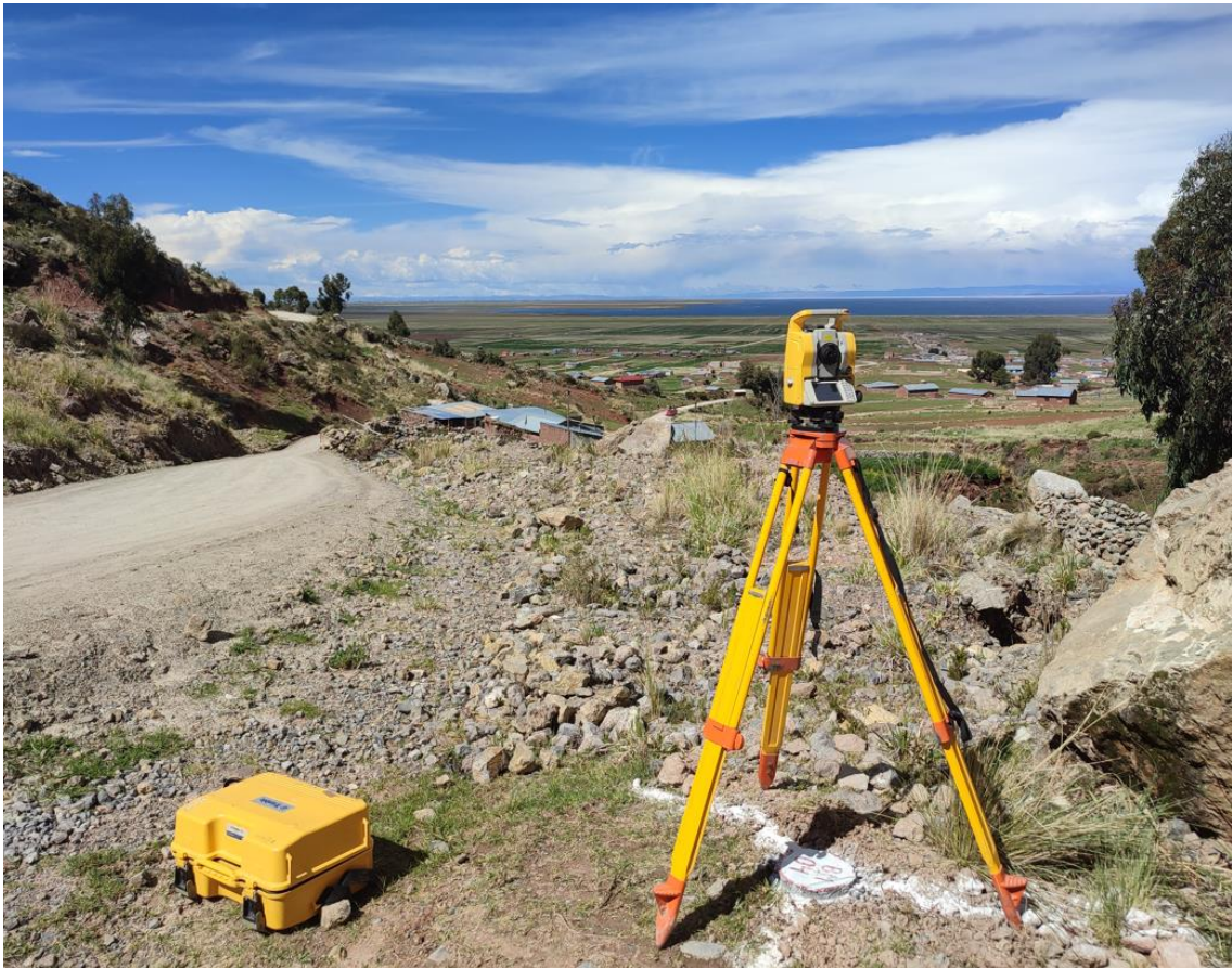
Figura 14: Levantamiento Topográfico Estación Total.
