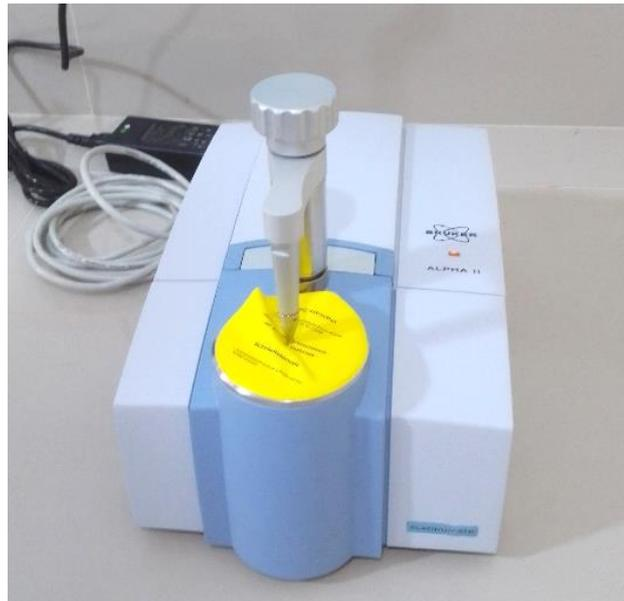
**Figura 14:** Equipo de FTIR, marca Bruker, modelo Alpha II.
