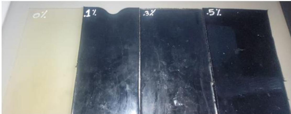
**Figura 12:** Elastómeros de poliuretano conformados 0%, 0.1%, 0.3% y 0.5% NT.
