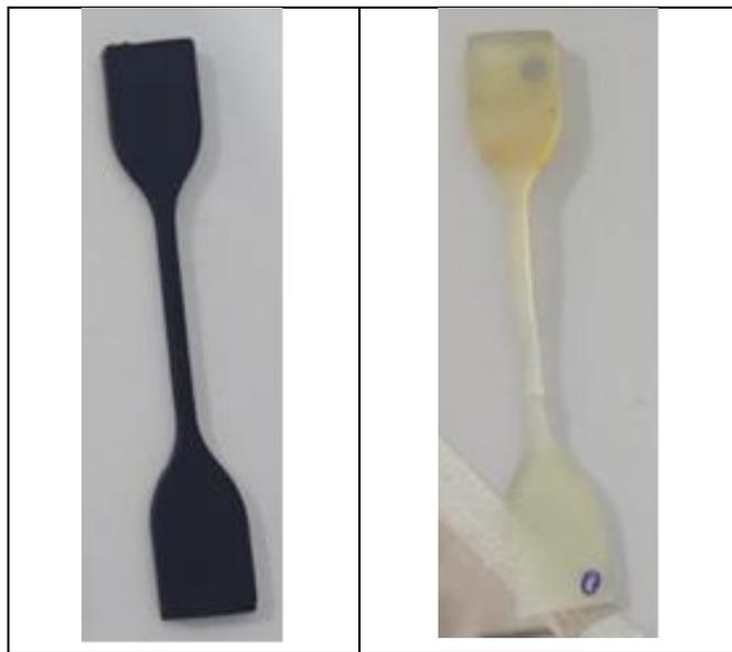
**Figura 18:** Probetas para el ensayo de tracción.
