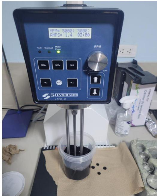
**Figura 10:** Equipo de mezclado de alto cizallamiento SILVERSON.
