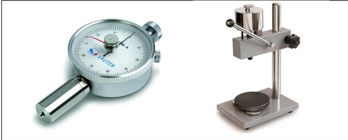
**Figura 20:** Durómetro y soporte para medir la dureza.
