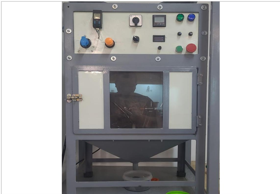
**Figura 16:** Máquina de erosión basada en ASTM G-76.
