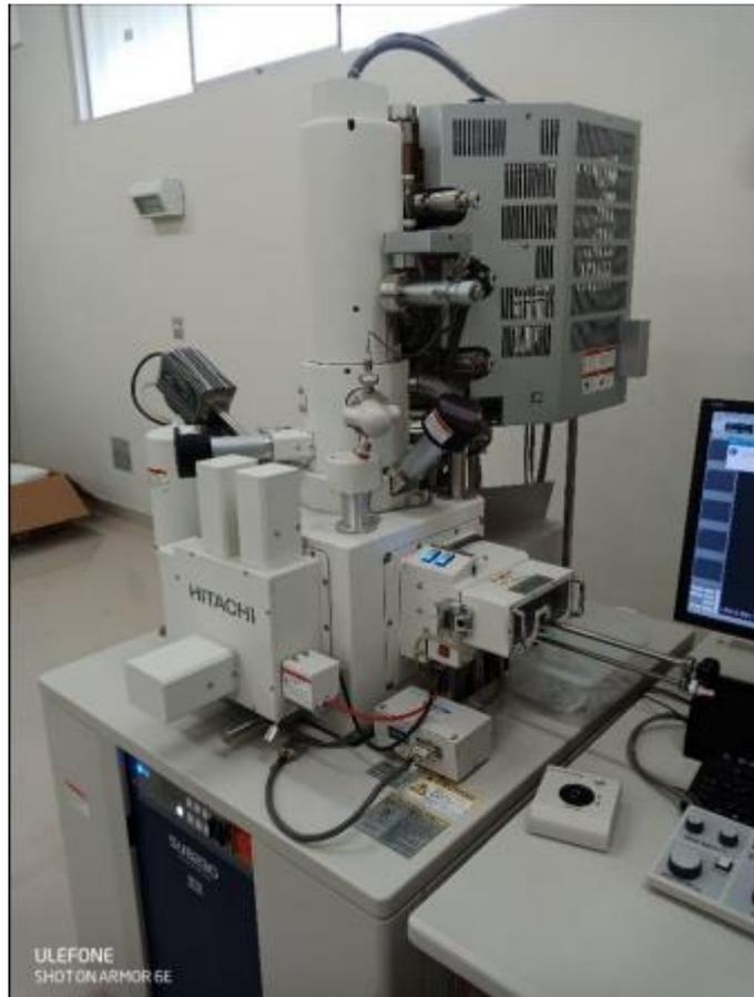
**Figura 21:** Microscopio electrónico de barrido (SEM) marca HITACHI.
