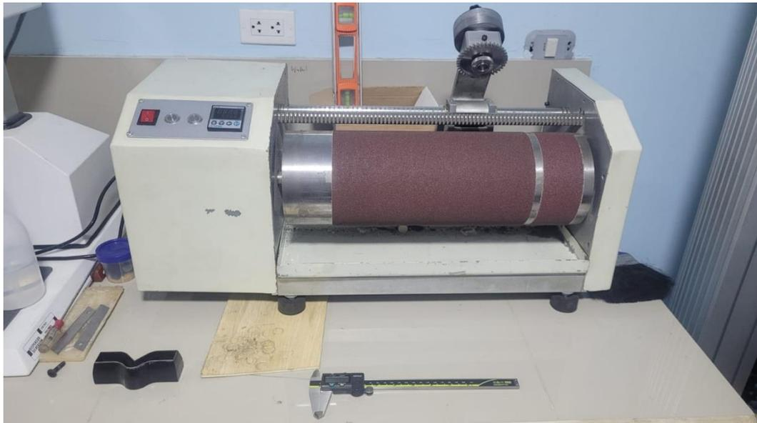
**Figura 15:** Equipo de abrasión bajo la norma ASTM 5963.
