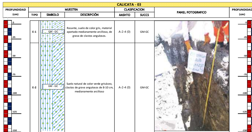
Perfil estratigráfico de la Calicata - 03
