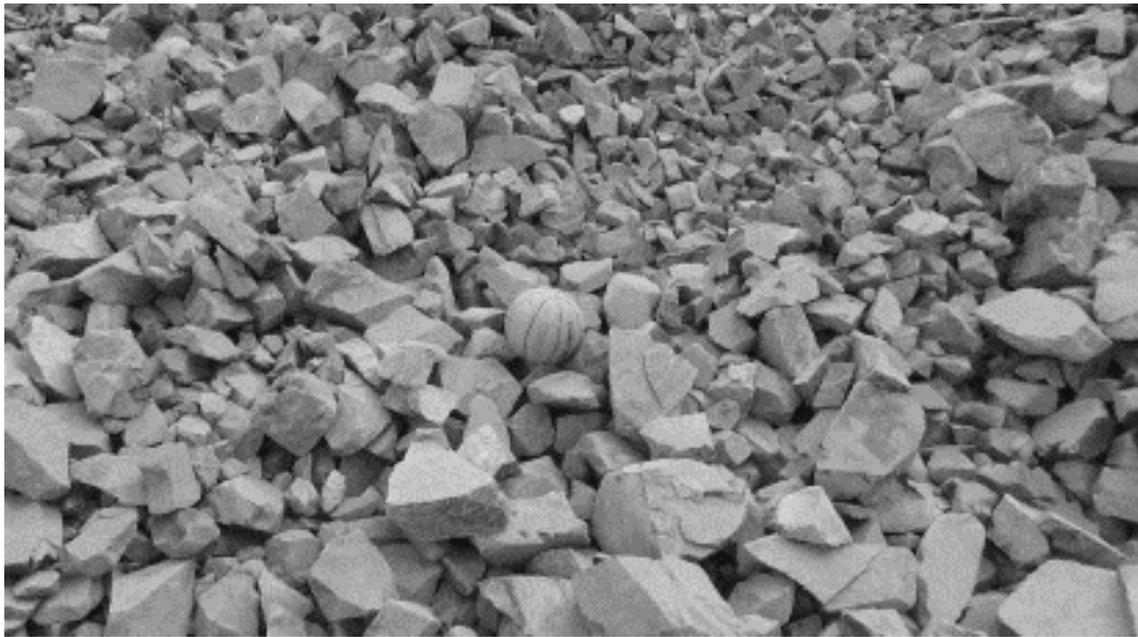
**Figura 93.** Fragmentación del tajo Scree Slope – Py – 4715 – 034.
