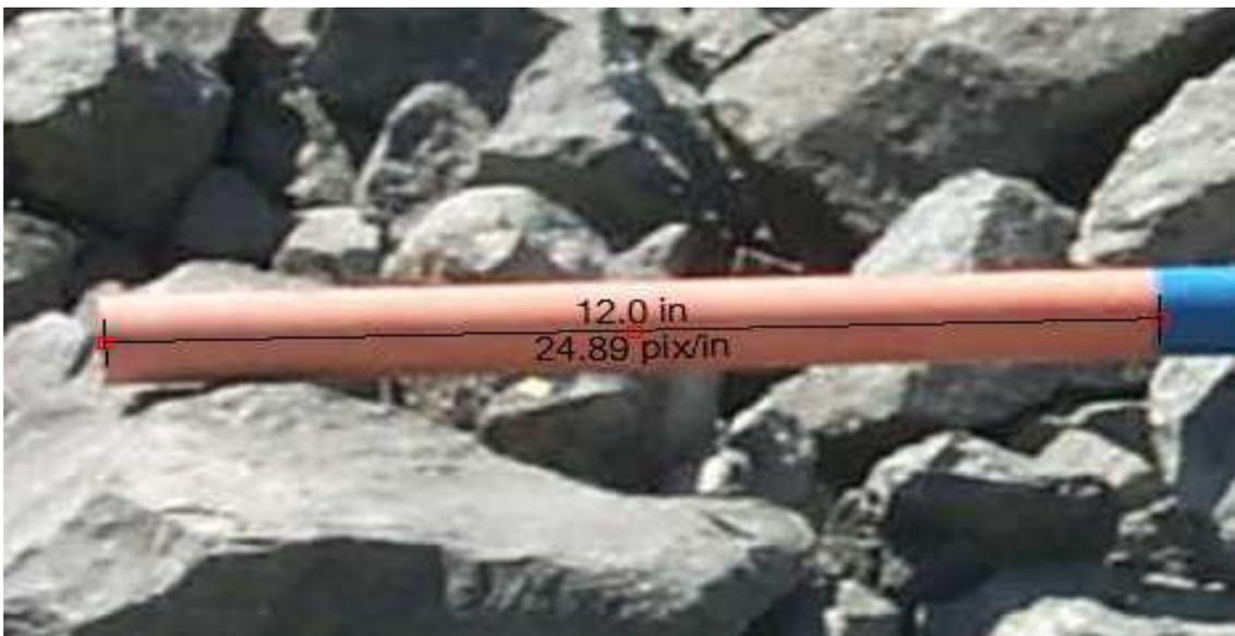
**Figura 7.** Imagen escala con la dimensión del objeto escalador.
