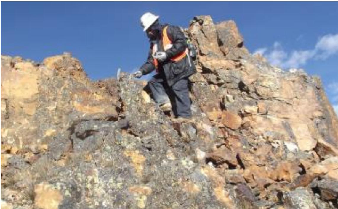
**Figura 28.** Limpieza y extracción con el uso de una picota.
