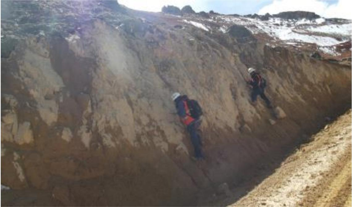
**Figura 29.** Extracción de los fragmentos a muestrear.
