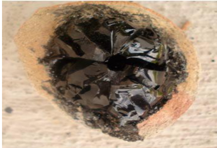
Figura 2. Fase escoria generada por fusión de una mezcla de óxidos de cobre y hierro, utilizando bórax como principal agente fundente.
