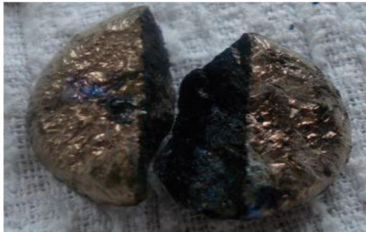
Figura 3. Fotografía de una fase mata generada en la fusión de un concentrado de sulfuros de cobre y hierro
