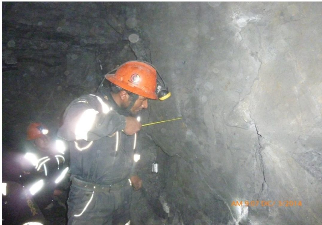
Foto 03. Medición del taladro perforado.
