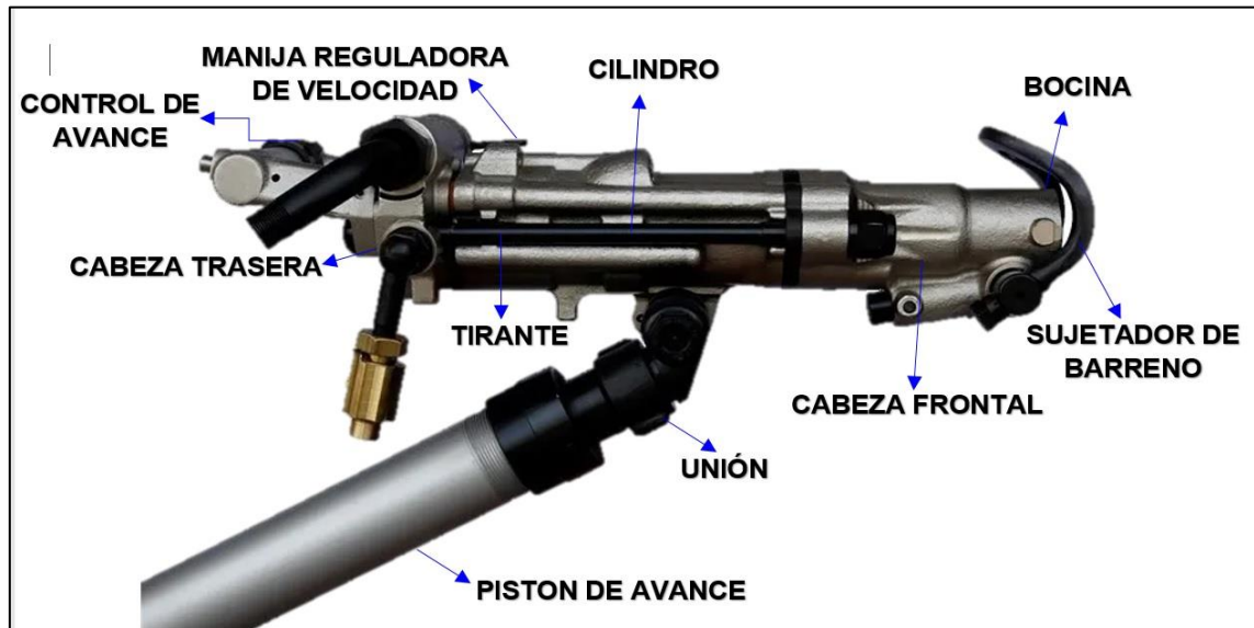
Figura 2. Componentes de máquina perforadora Jack Leg
