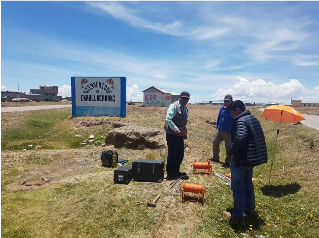
Figura 45. Realización de Sondaje Eléctrico Vertical 1 Sector Quety Chaullacamani
