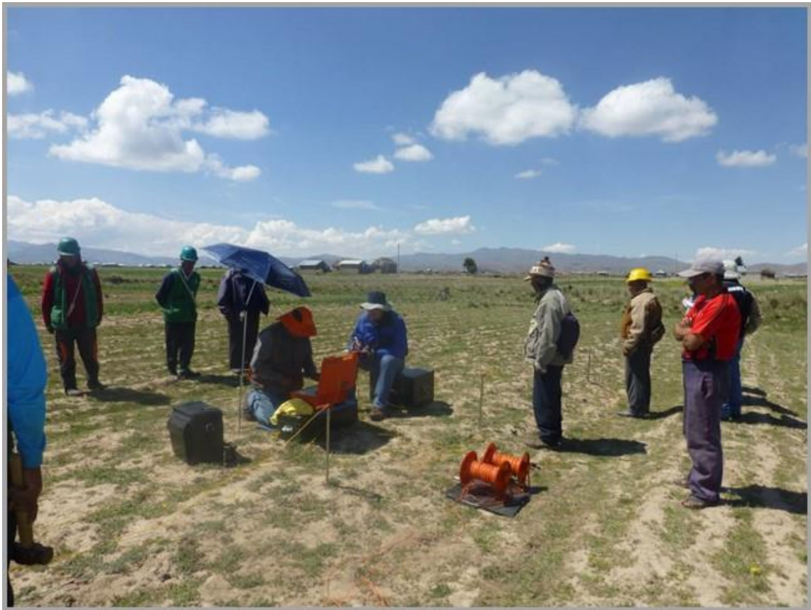
Figura 47. Realización de Sondaje Eléctrico Vertical 1 en el sector Sancuta
