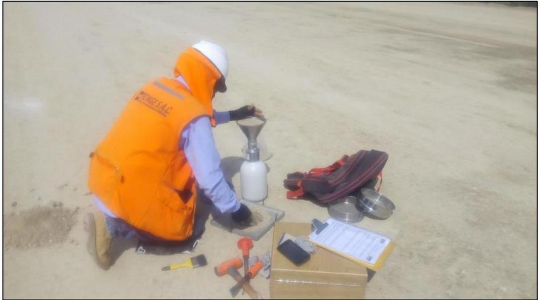
**Figura 8.** Ensayo cono de arena
