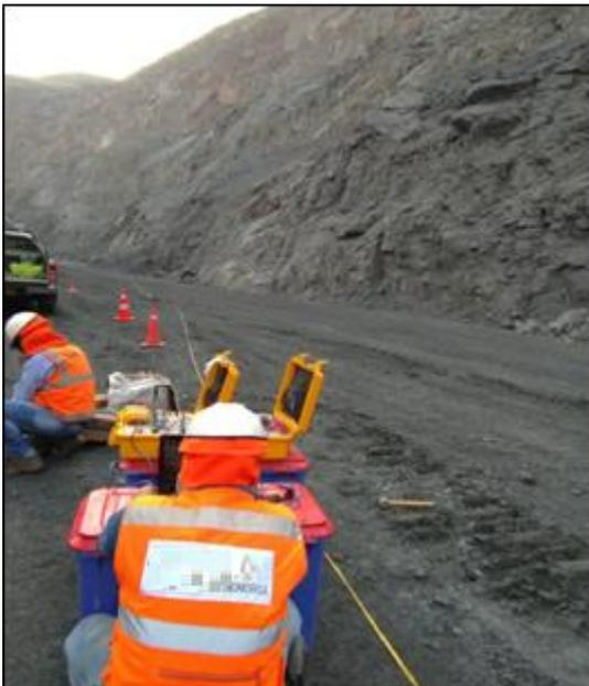
**Figura 56.** Vista de la línea de tomografía eléctrica TM-01 en Mina 9-10
