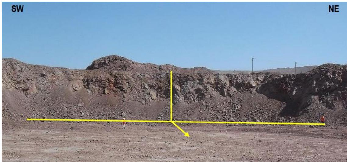
**Figura 48.** Vista de la EG-05, Nivel 713 donde se realizó la línea de detalle de 50 m de longitud. Con dirección de buzamiento del talud:  $018^\circ$  y buzamiento de talud:  $58^\circ$ .
