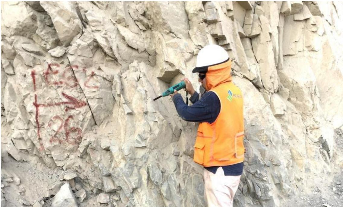
**Figura 53.** Vista de ejecución del ensayo del Martillo Schmidt en la estación geomecánica EG-26.
