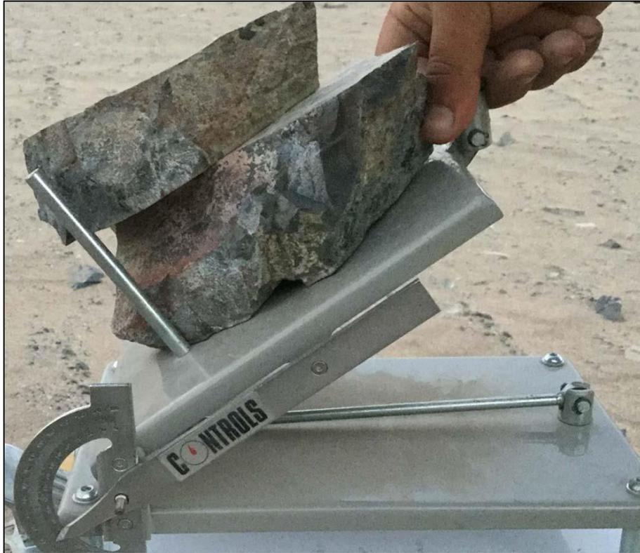
**Figura 54.** Ensayo Tilt Test, Estación Geomecánica EG-13
