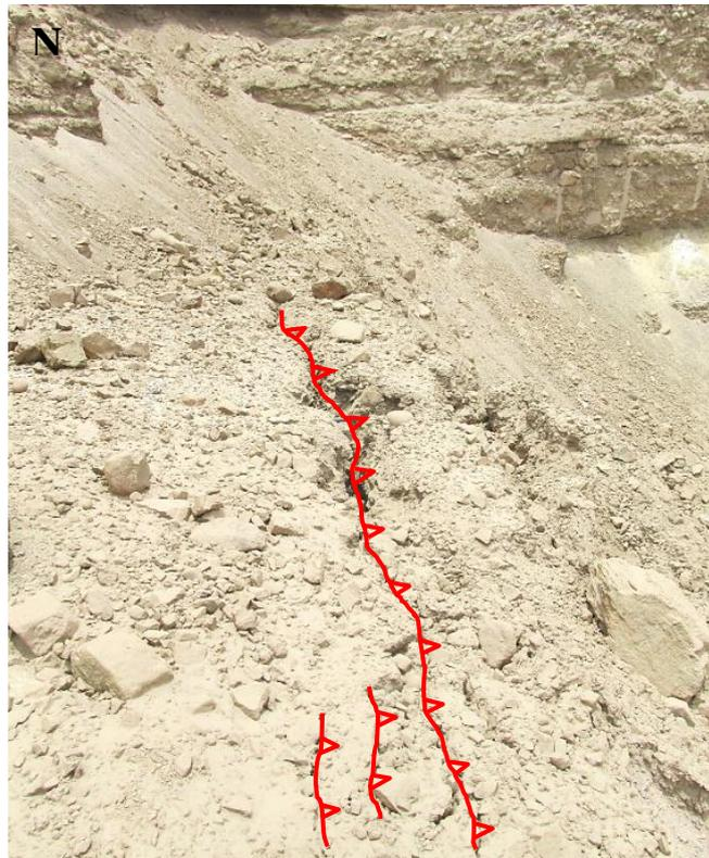
**Figura 14.** Ejemplo de Zona de Agrietamiento en la Mina 9 (AG-02) Riesgo Extremo
