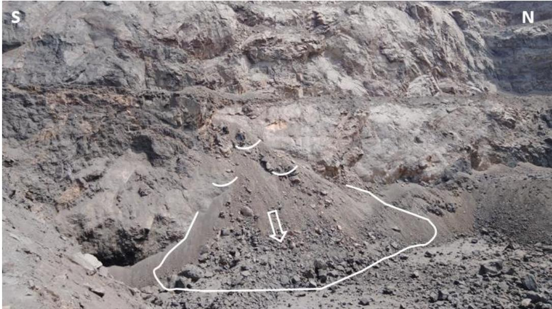
**Figura 13.** Ejemplo de Zona de Deslizamiento en la Mina 10, cara Suroeste, del Nivel 605 al Nivel 569, DZ-01' Riesgo Moderado
