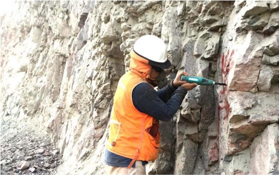
**Figura 52.** Vista de ejecución del ensayo del Martillo Schmidt en la estación geomecánica EG-41.
