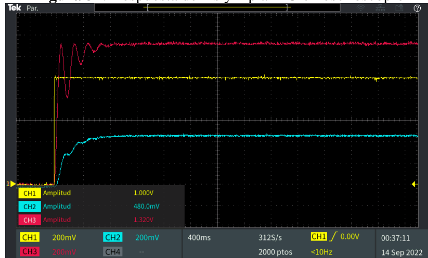
Figura 34: Respuesta de Hs y Hp al EU en osciloscopio
