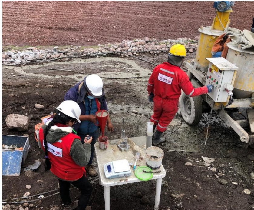
Figura 38. Ensayo de cono de Marsh para estimar la fluidez de la mezcla.
