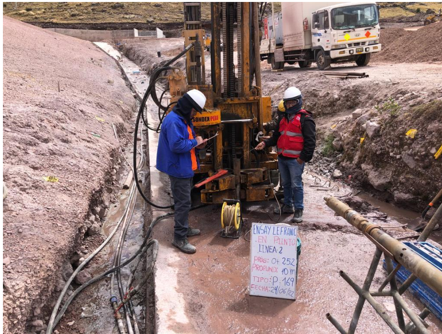
Figura 21. Ensayo de permeabilidad Lefranc.
