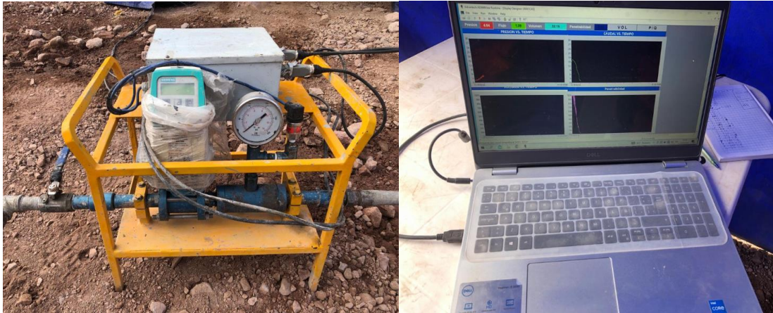
Figura 50. Caudalímetro y registro de inyección en tiempo real.
