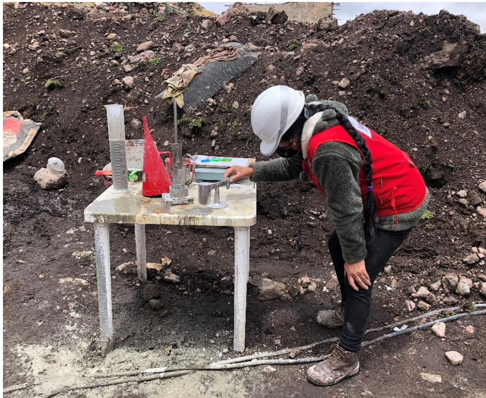
Figura 24. Ensayos de calidad de lechada.
