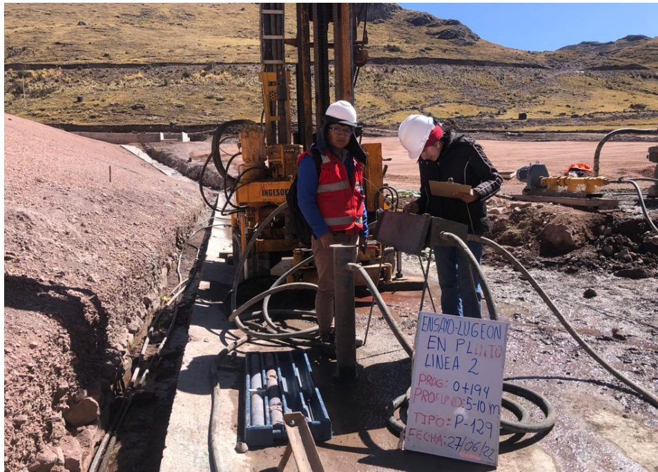
Figura 22. Ensayo de permeabilidad tipo Lugeon.
