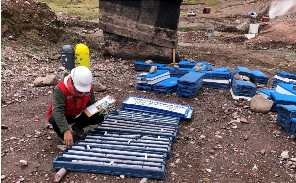
Figura 20. Logueo geotécnico de las cajas de perforación.
