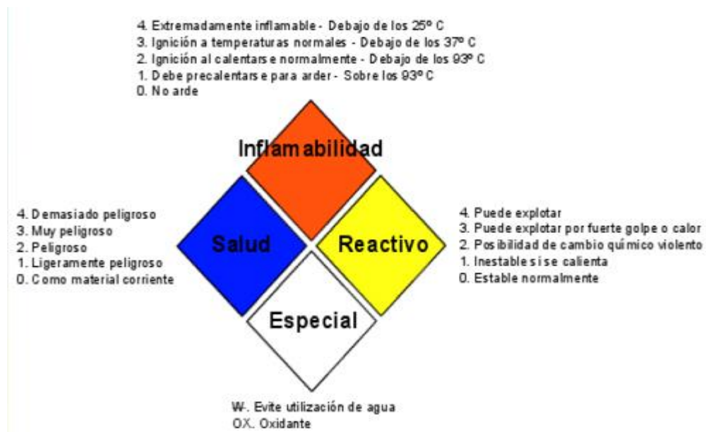
Figura 5. Información de MAT-PEL según Norma NFPA 704
