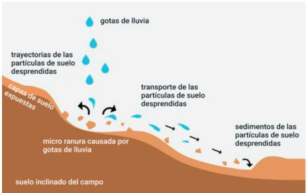
Figura 4. Transporte y sedimentación de las partículas de suelo desprendidas.
