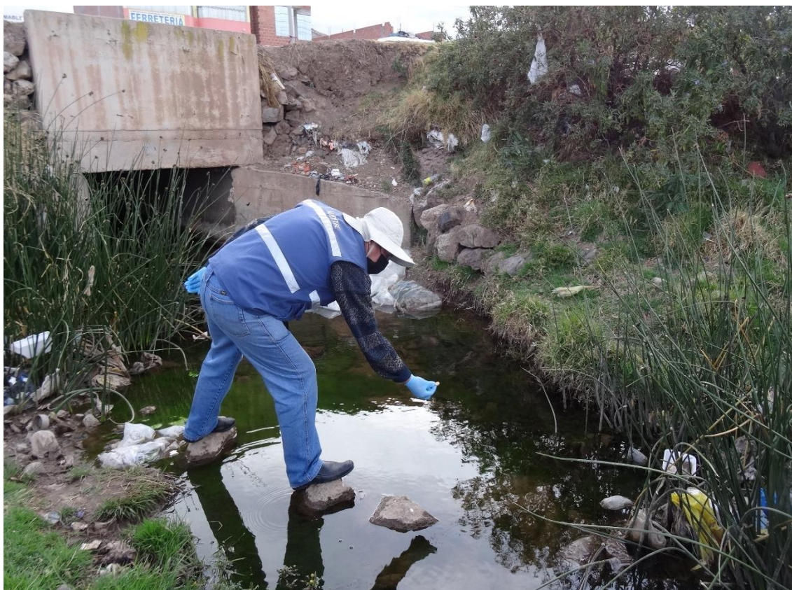
Anexo 9. Medición del caudal del Arroyo con el método del corcho.
