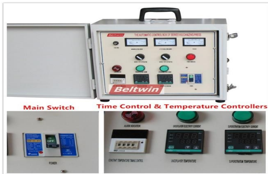
Figura 39. Caja de control de temperatura.
