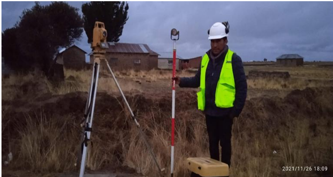
Figura 31. Estación Total estacionado en el Punto Geodésico EDLLM-001
