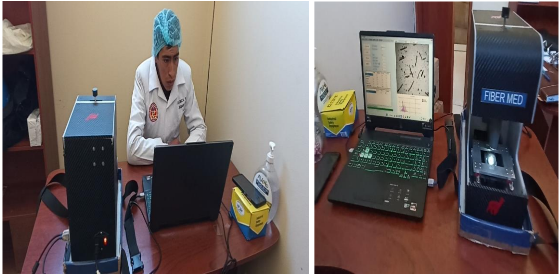
Figura 4. Análisis de muestras en el OFDA 2000.
