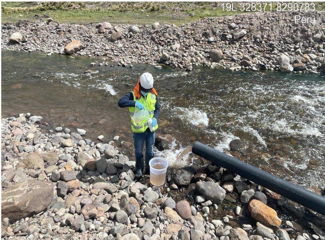
**Figura 14.** Obtención de muestras del punto de vertimiento al río Paratia.
