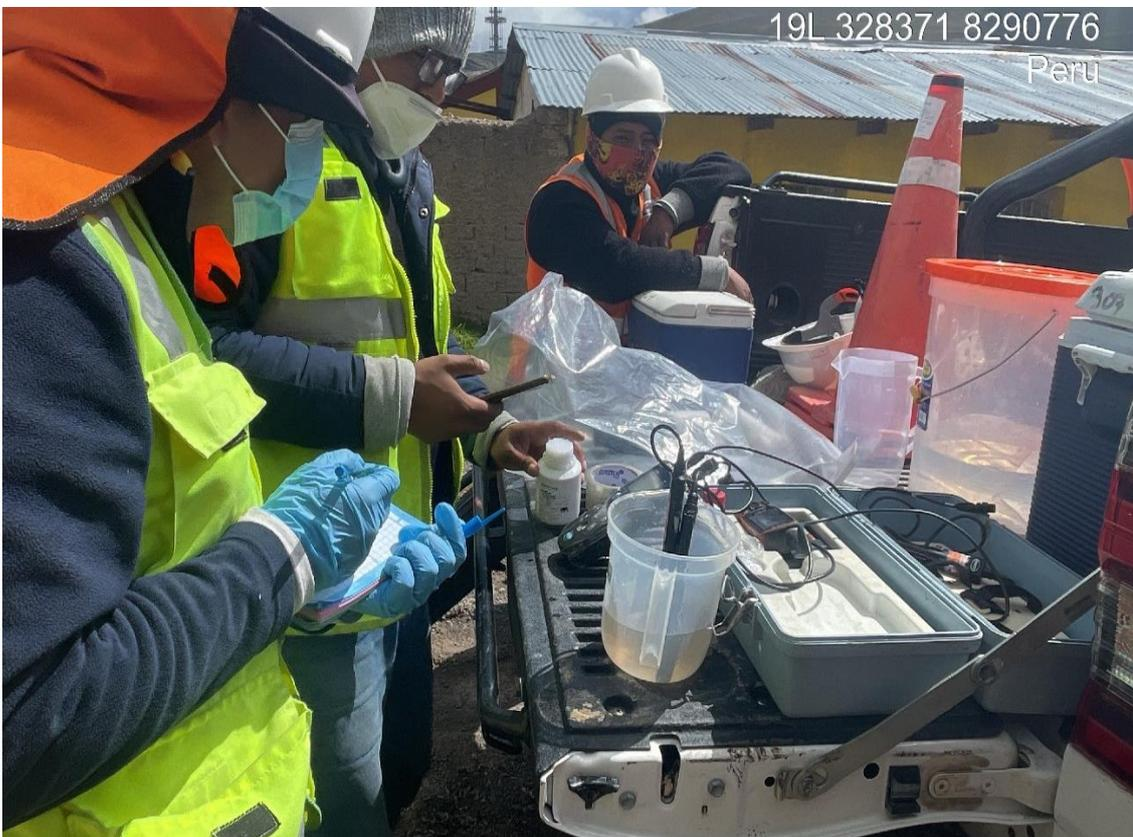
**Figura 13.** Lecturas de parámetros “*in situ*” según protocolo de monitoreo de agua.
