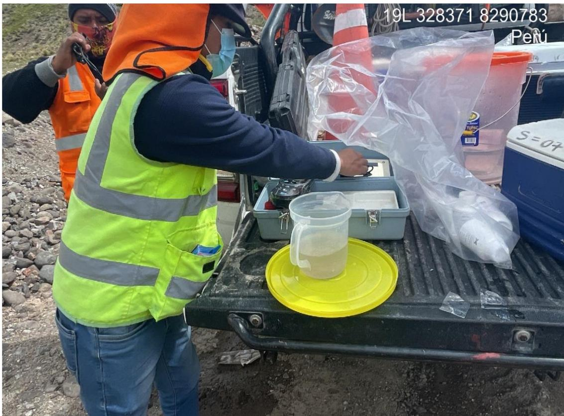
**Figura 15.** Medición de parámetros físicos en el punto de vertimiento al río Paratia.
