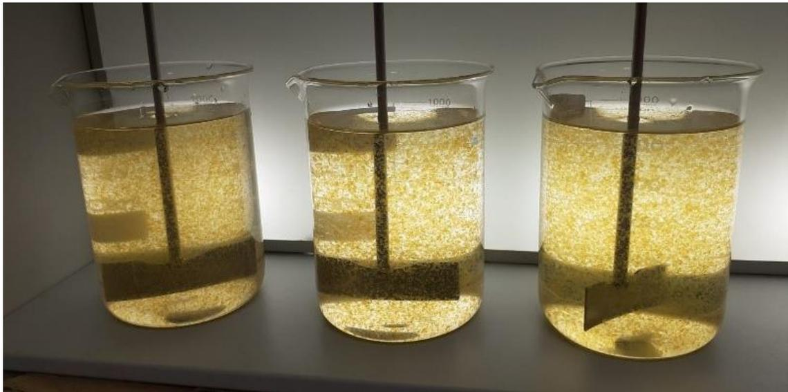
**Figura 16.** Equipo de prueba de jarras en el laboratorio de químico.
