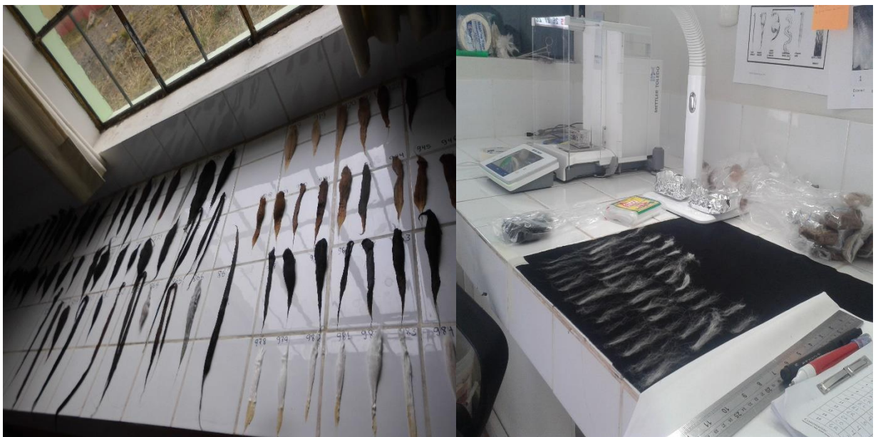
Figura 19. Secado de muestra de fibra de llama y proceso de descordado de muestras
