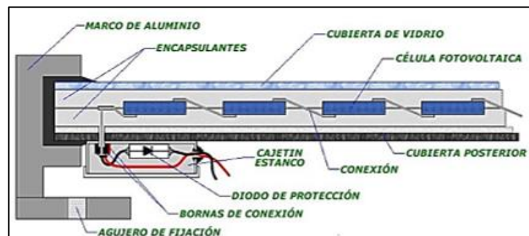
Figura 11: Esquema de Conexión Interna de un Módulo Fotovoltaico
