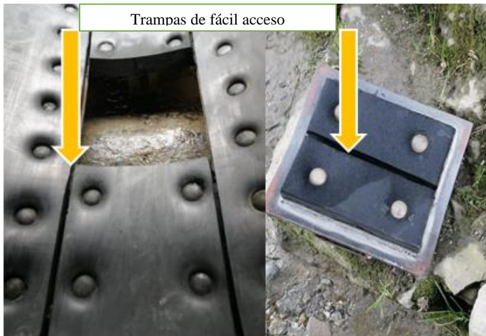
**Figura 7.** Trampas de fácil acceso caladas en la chaqueta de goma al interior del molino
