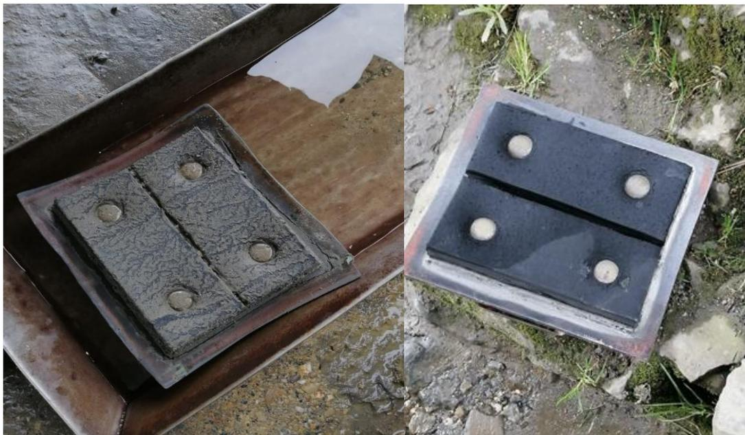
**ANEXO H.** Imagen de la obtención del concentrado de oro de la trampa óptima 0.8 cm del molino y a una densidad óptima de la pulpa 1400 g/L.
