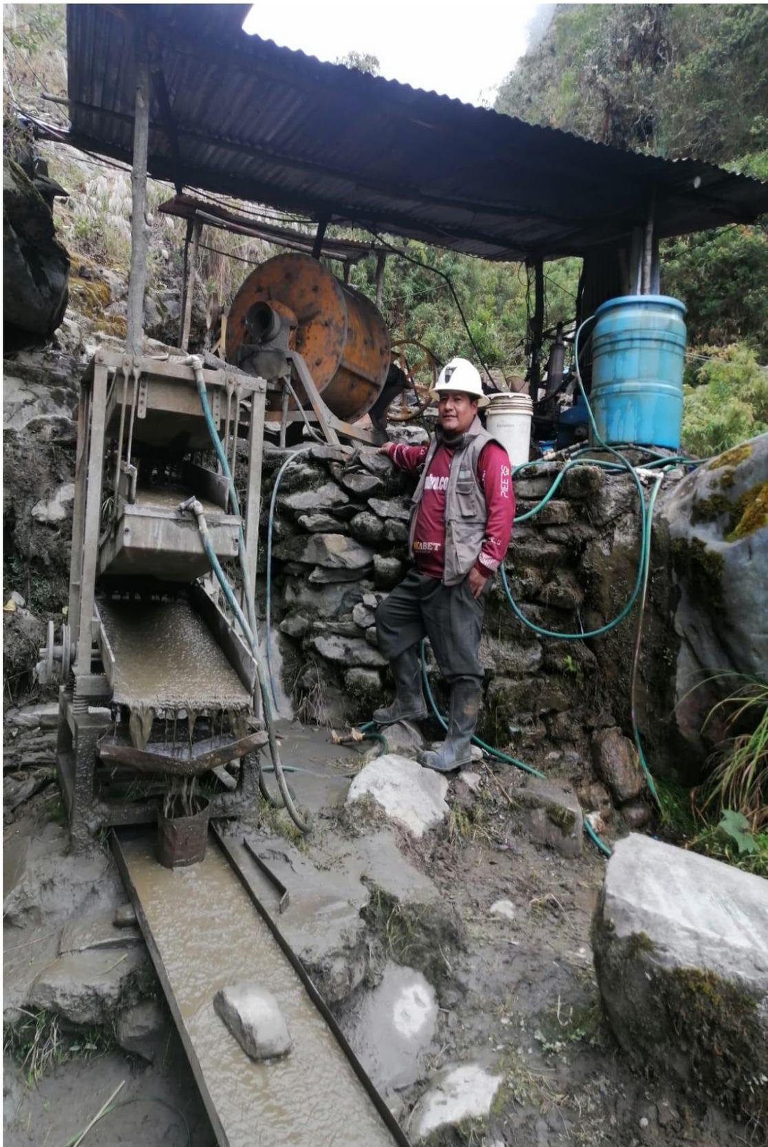
**ANEXO F.** Imagen de la descarga del concentrado de las trampas de fácil acceso del molino.
