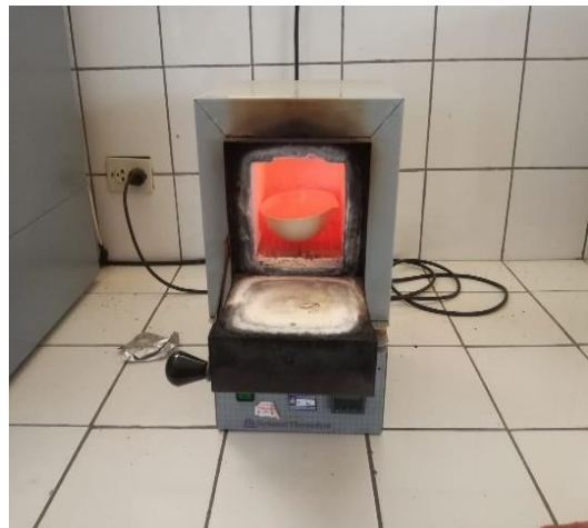
Figura 25. Puzolana en la mufla a 800°C
