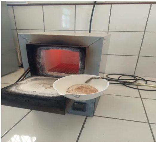
Figura 22. Introduciendo la puzolana a la mufla
