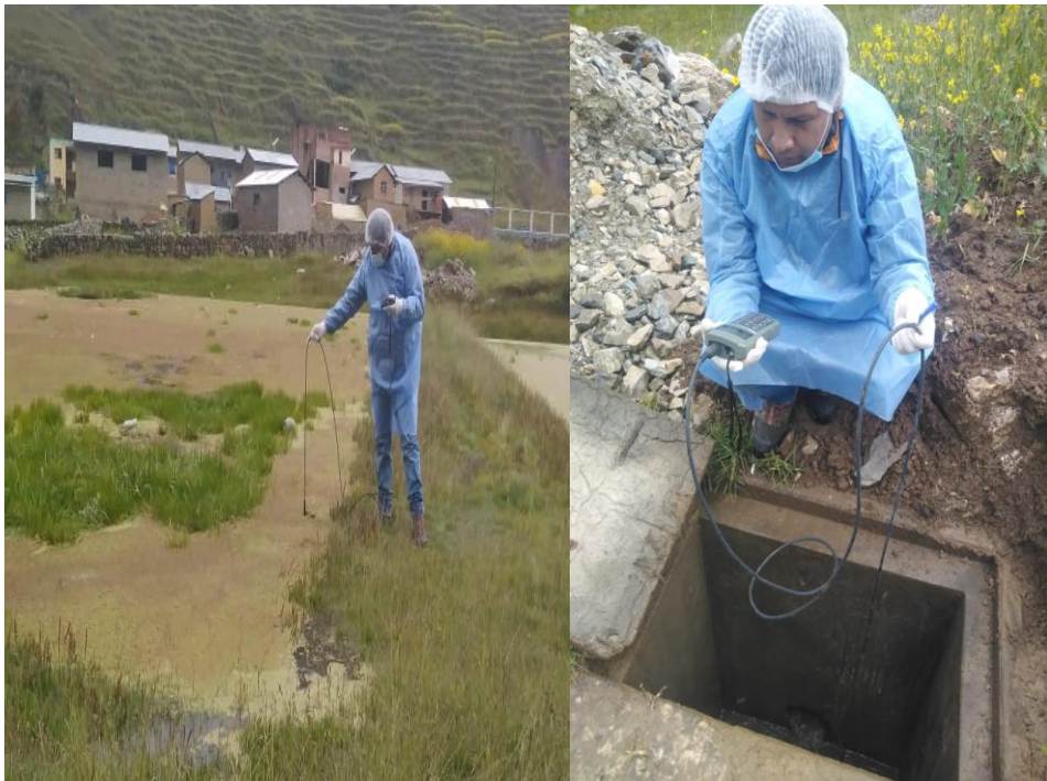
Figura 21. Medición de parámetros de campo en las lagunas de oxidación
