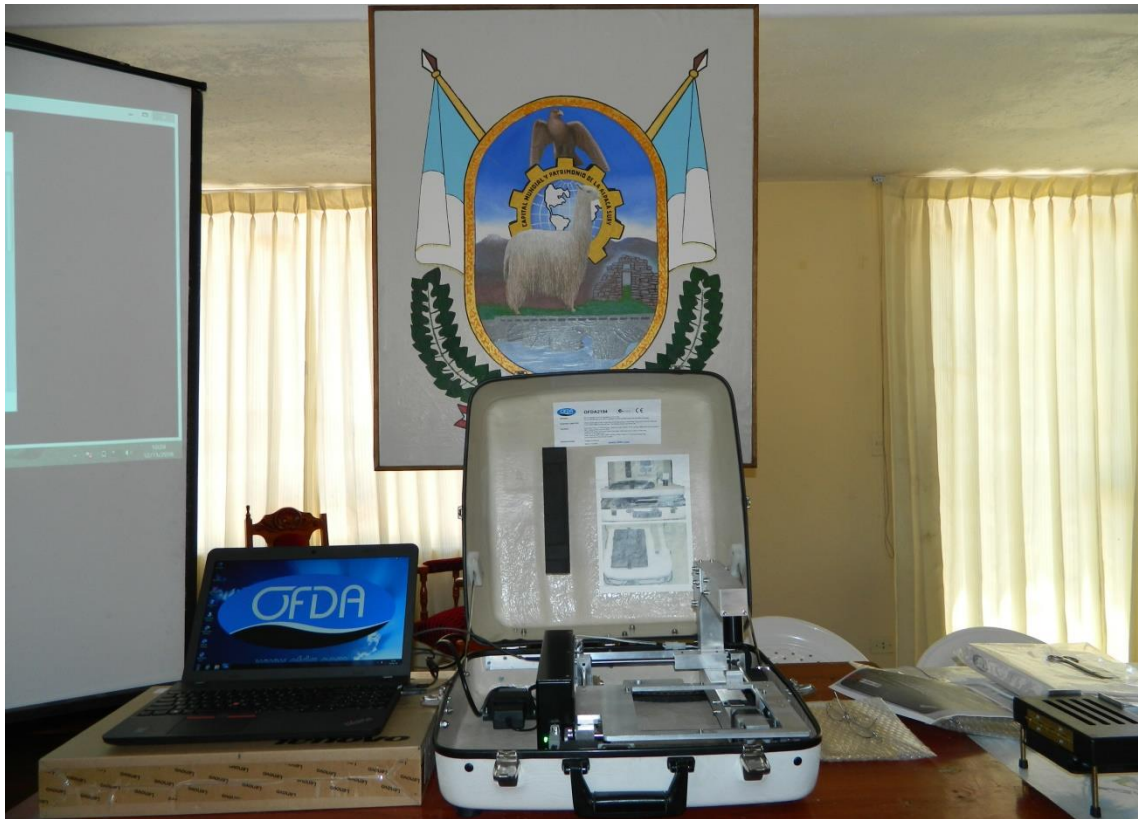
Figura 7. Equipo Analizador Óptico de Diámetro de Fibra (OFDA 2000) Nuñoa
