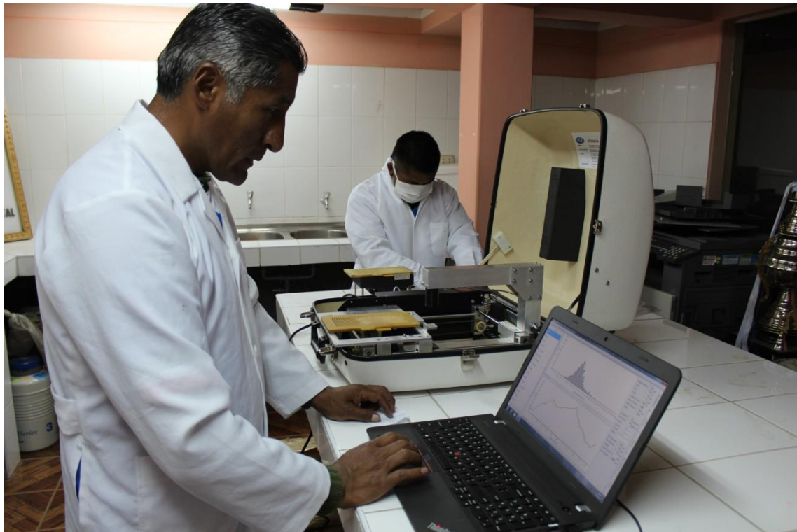
Figura 8. Trabajo de medición de fibra en el equipo OFDA 2000
