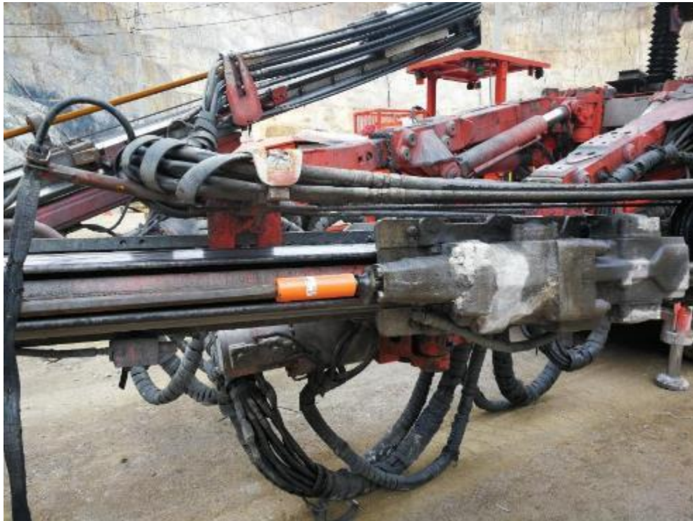
Figura 02: Mangueras, cañerías, conectores hidráulicos “Jumbo DD321”
