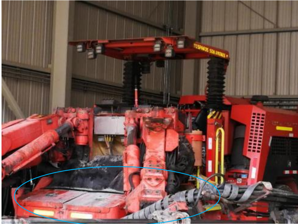
Figura 01: Mangueras, cañerías, conectores (Implementos) “Jumbo DD321”
