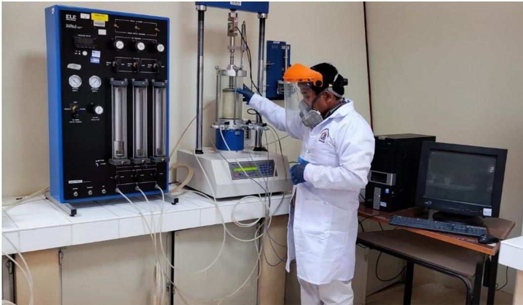
*Figura 16.* Procedimiento del ensayo triaxial.
