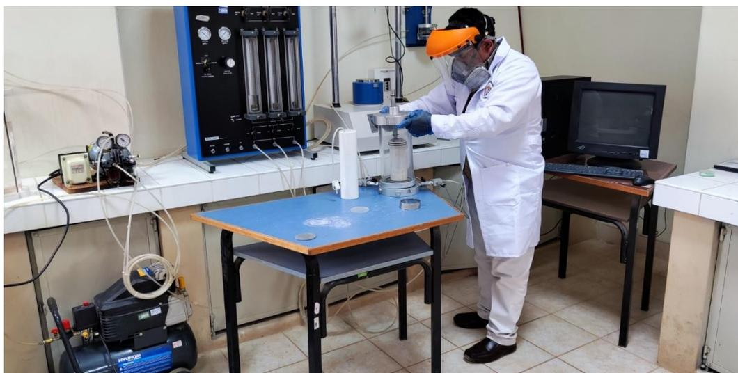
*Figura 15.* Colocación de la celda triaxial.
