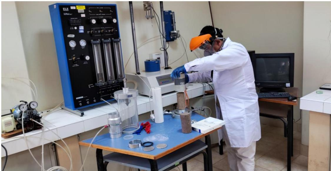
*Figura 12.* Ensamblaje de la membrana de látex con el tubo expansor.
