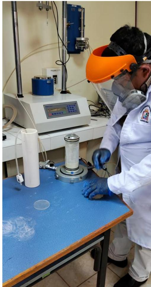
*Figura 14.* Colocado de los aros de hule, piedra porosa y pedestal de carga.
