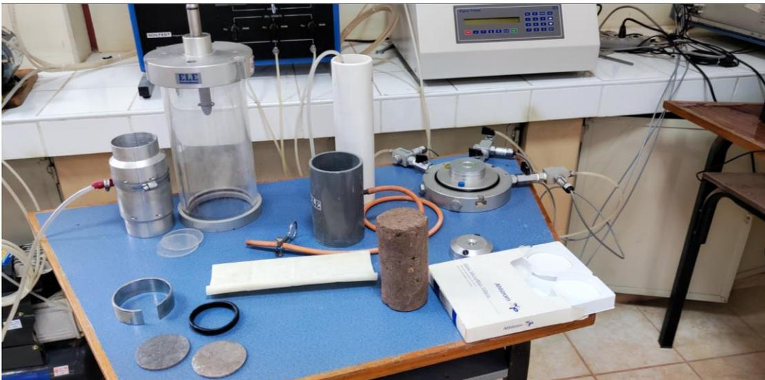
*Figura 11.* Accesorios de la celda triaxial.
