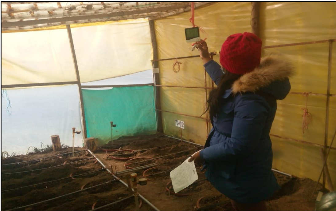
Foto 02. Lectura de la temperatura y humedad relativa.
