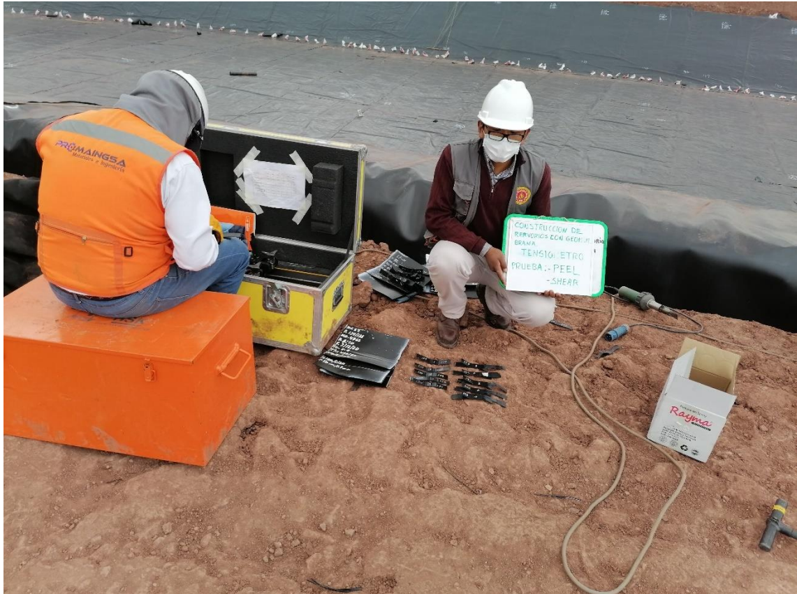
Figura 7. Se observa los testigos ensayados por destructivo en el tensiómetro .
