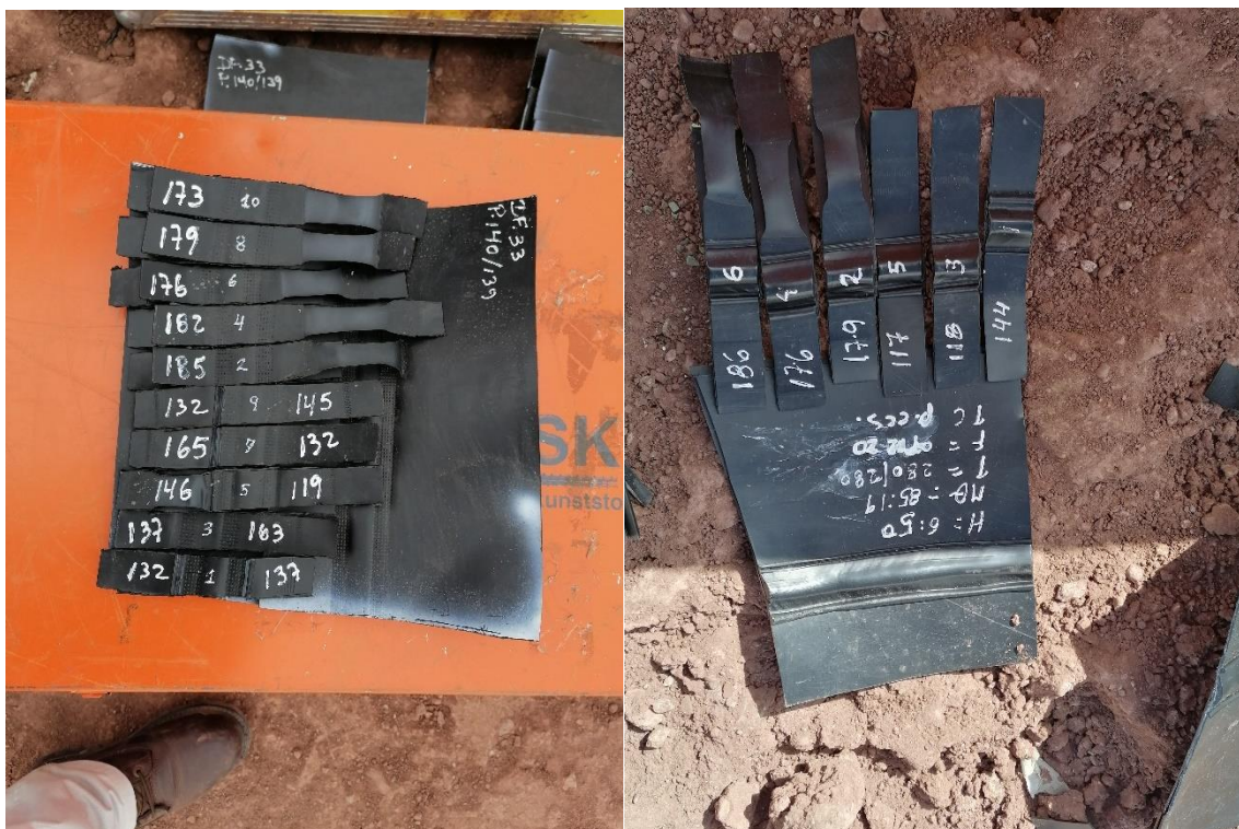
Figura 11. Testigos destructivos por fusión y extrusión donde se aprecia el desgarro (peel) y el corte (Shear).
