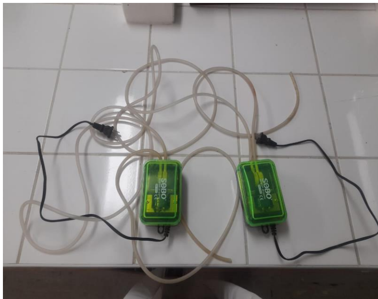
Figura 25. Sistema de oxidación del sistema de tratamiento
