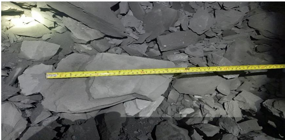
Figura 9. Fragmentación de la roca con dinamita semigelatina 65%
