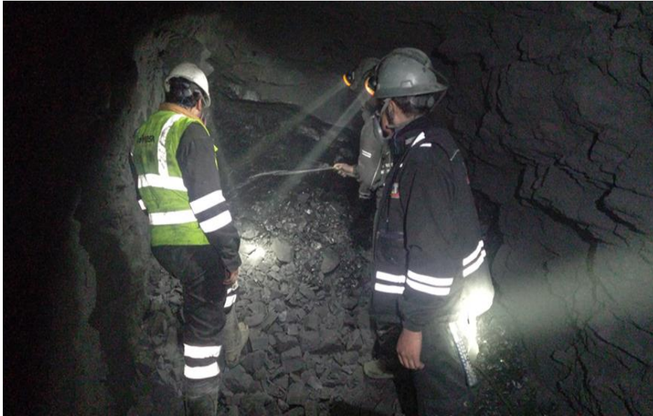
Figura 11. Fragmentación de la roca con emulnor 3000.
