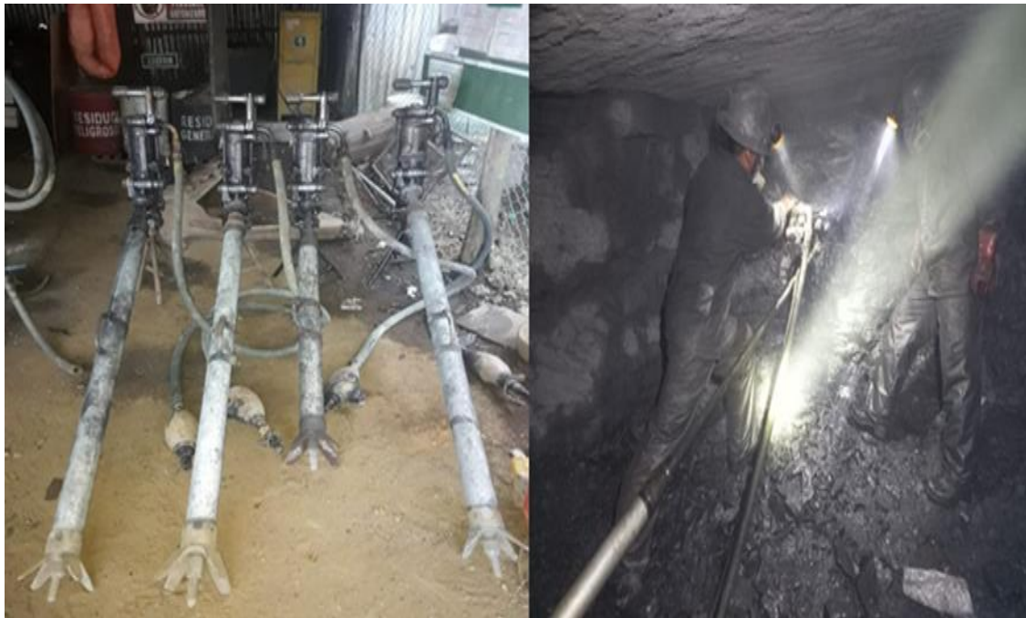
Figura 3. La perforadora y la perforacion en el frente.
