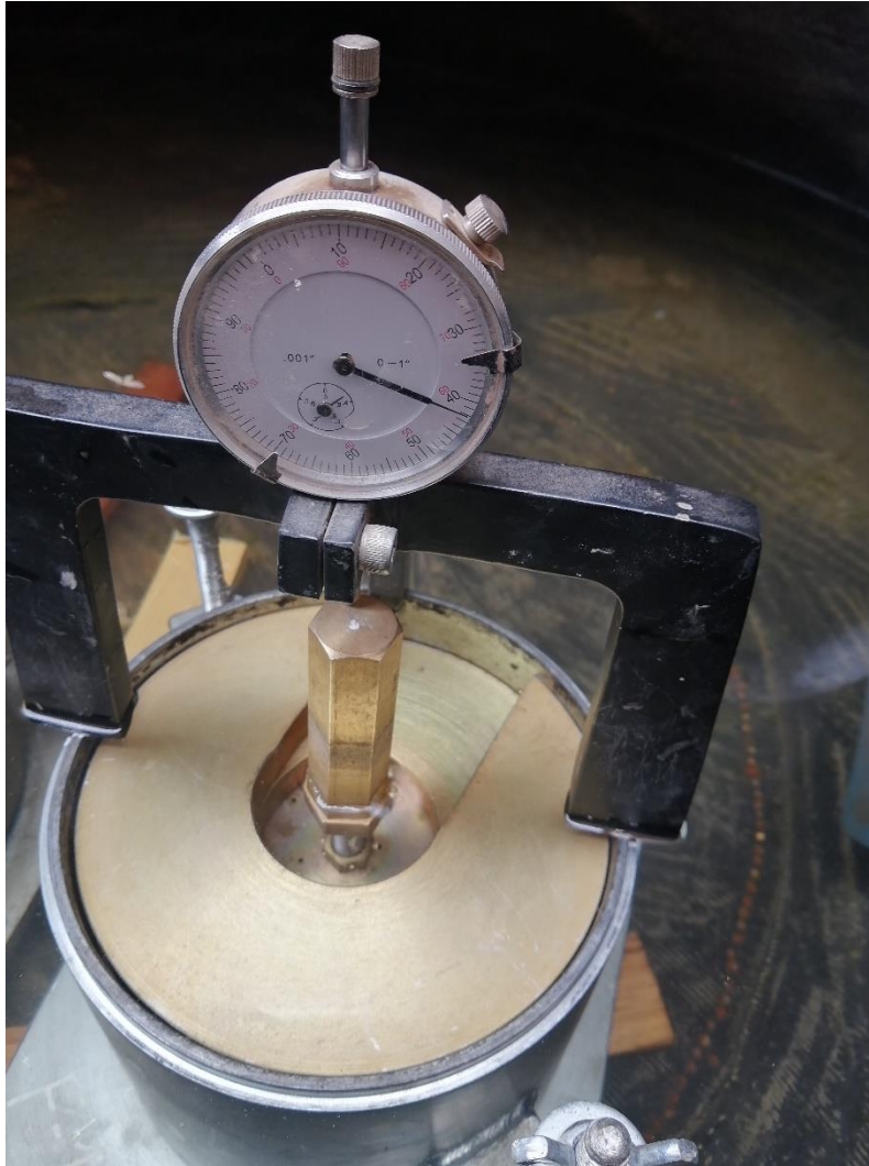
FOTOGRAFÍA E -8: Se muestra el d'jal utilizado para medir de las deformaciones y el penetrómetro del CBR.
