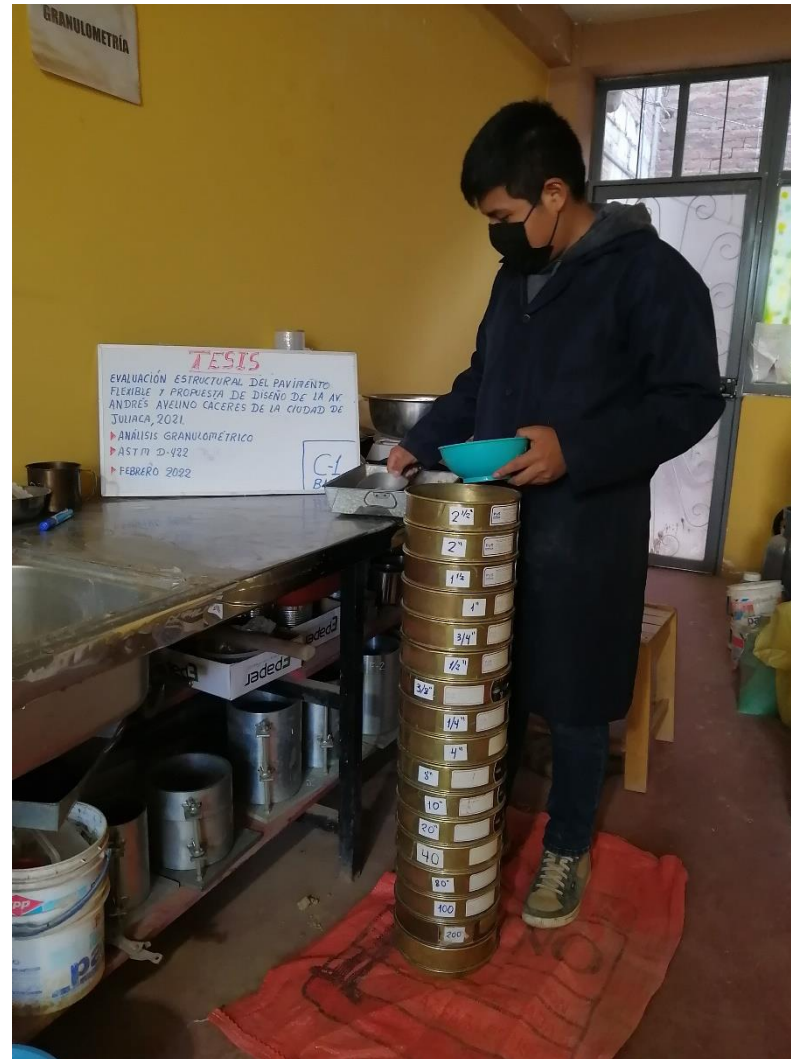
FOTOGRAFÍA E -6: Tamizado del material para obtener la granulometría de cada tipo de suelo.
