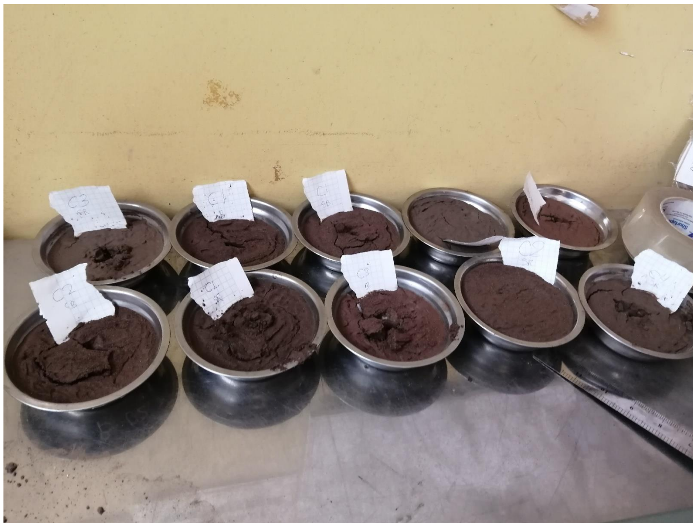
FOTOGRAFÍA E -5: Muestras de suelo que sirvieron para realizar el ensayo de límites de consistencia, hallando de esta forma el índice de plasticidad.
