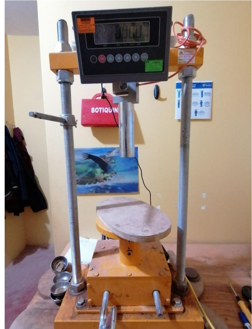
FOTOGRAFÍA E -8: Se muestra el d'jal utilizado para medir de las deformaciones y el penetrómetro del CBR.
