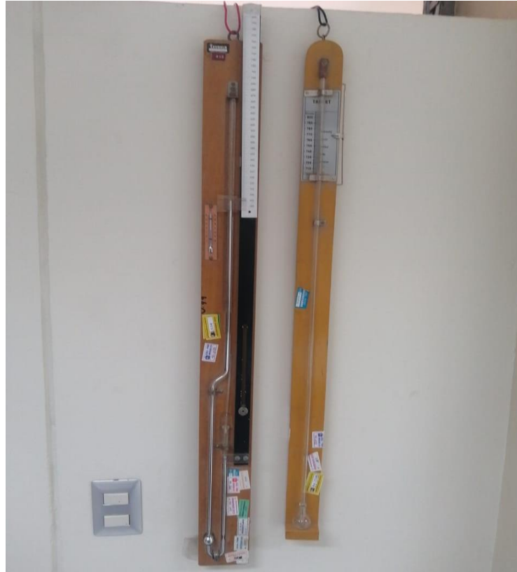
Figura 25: Barómetro de sifón del Laboratorio de Física (FICA-UNAP).
