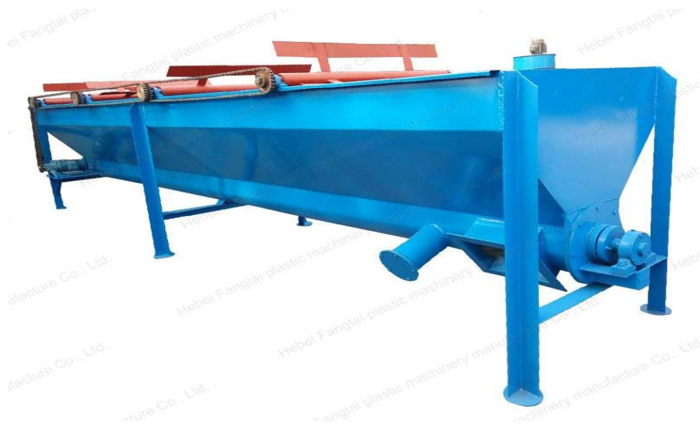
Figura 25: Tanque de lavado en frío
