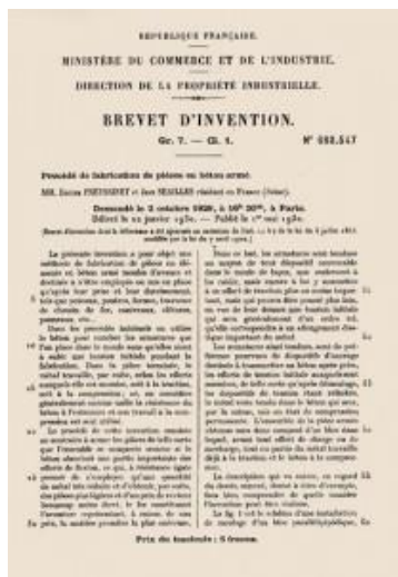
Imagen 1. Primer Invento de Eugene Freyssinet – Concreto Pretensado / Eugene Freyssinet
