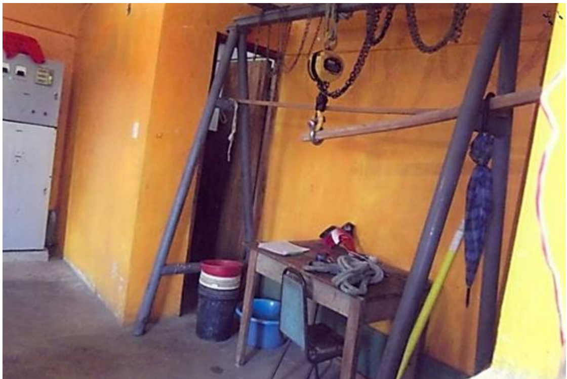
Figura 100. Caballete, equipado con tecle, para ser usado en tareas de mantenimiento
