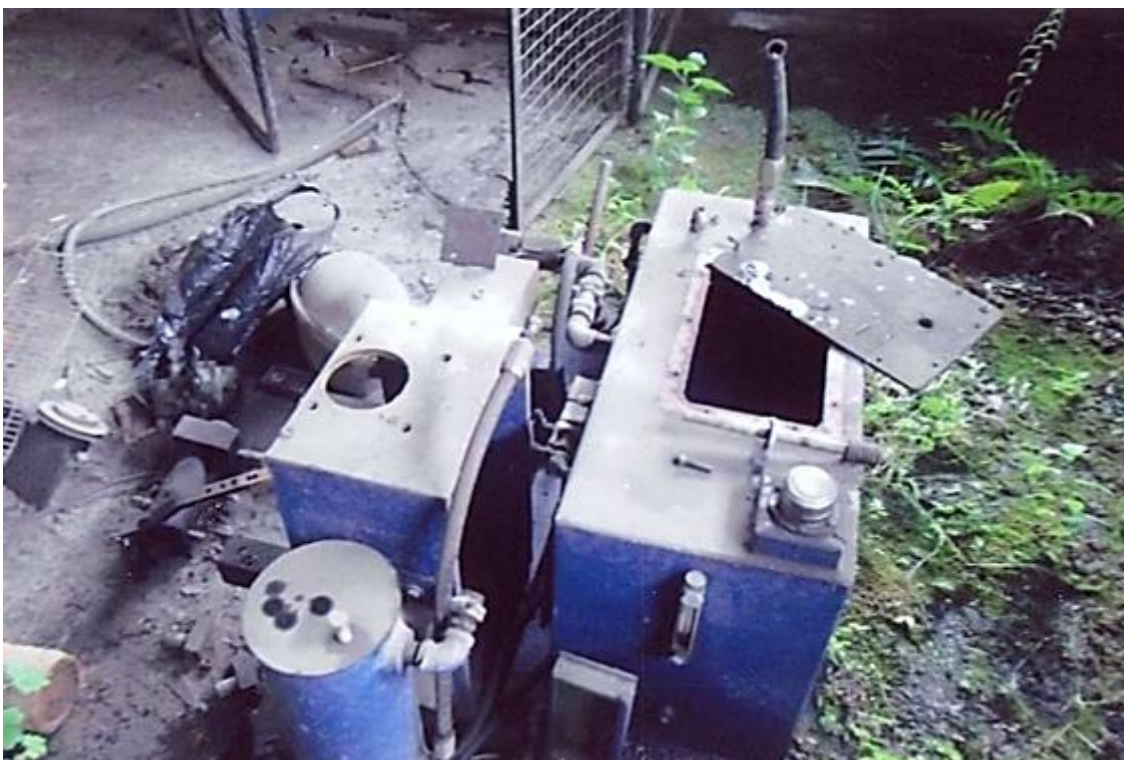
Figura 46. Regulador de velocidad, también desmantelado.
