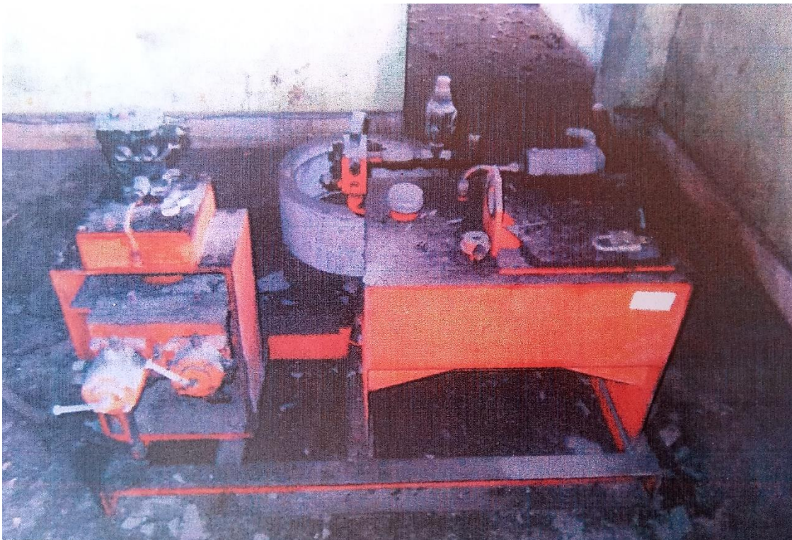
Figura 30. Regulador de velocidad, incompleto. Fuente: Leonel Castillo (2018).
